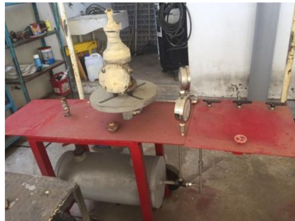
Figura 1.3. Montaje final de una válvula en un banco de pruebas de fabricación artesanal
