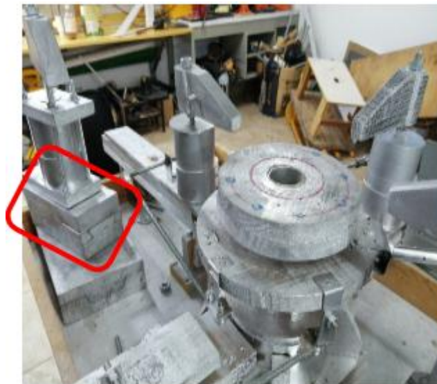
Figura 3.9. Soporte guía con diseño de cola de milano
