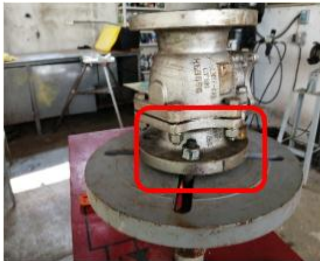
Figura 3.13. Sujeción de válvula en banco
