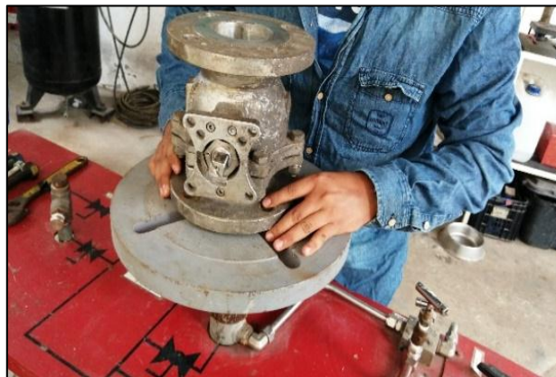
Figura 1.1. Presentación de una válvula en un banco de pruebas de fabricación artesanal
