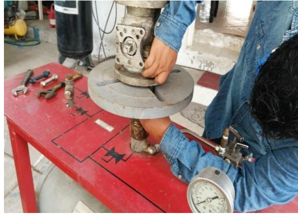
Figura 1.2. Colocación de tornillos en una válvula en un banco de pruebas de fabricación artesanal
