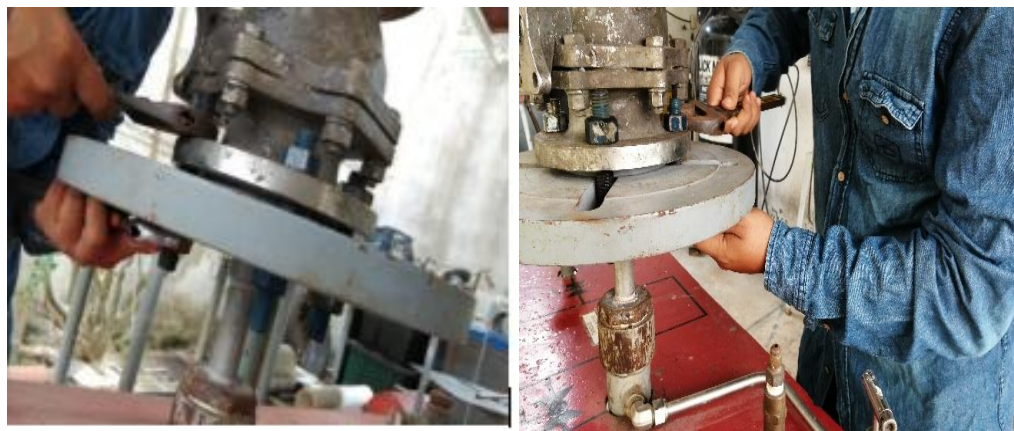
Figura 2.16 Sujeción tradicional usando tornillos
