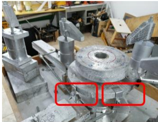
Figura 3.7. Vista donde se muestra la ubicación de la rótula
