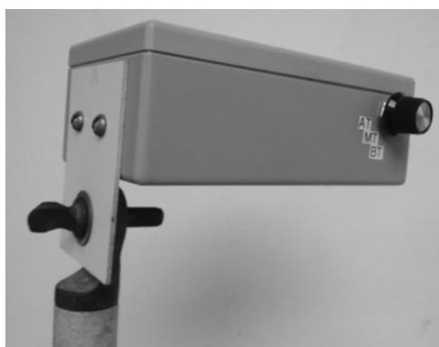
Figura A.5 Vista lateral de módulo detector montado sobre una pértiga aislante de cabezal universal.
