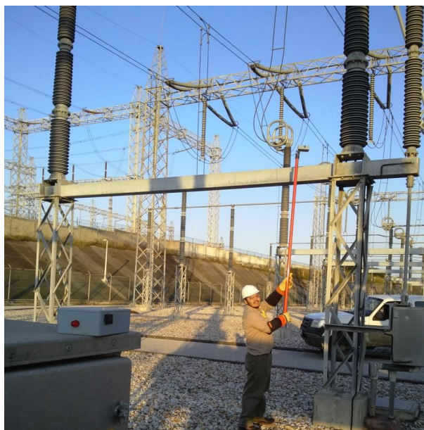
Figura 6.2. Prueba del dispositivo detector, comprobando la oportuna detección de voltaje, S. E. 400 kV Altamira III y IV, cuchilla A3511 fase C.
