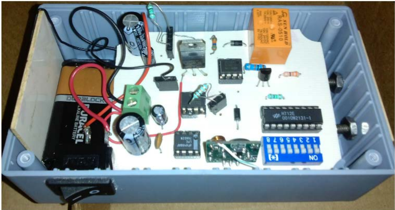
Figura 5.19. Vista interior de etapa principal con componentes electrónicos soldados, montado sobre su gabinete plástico.
