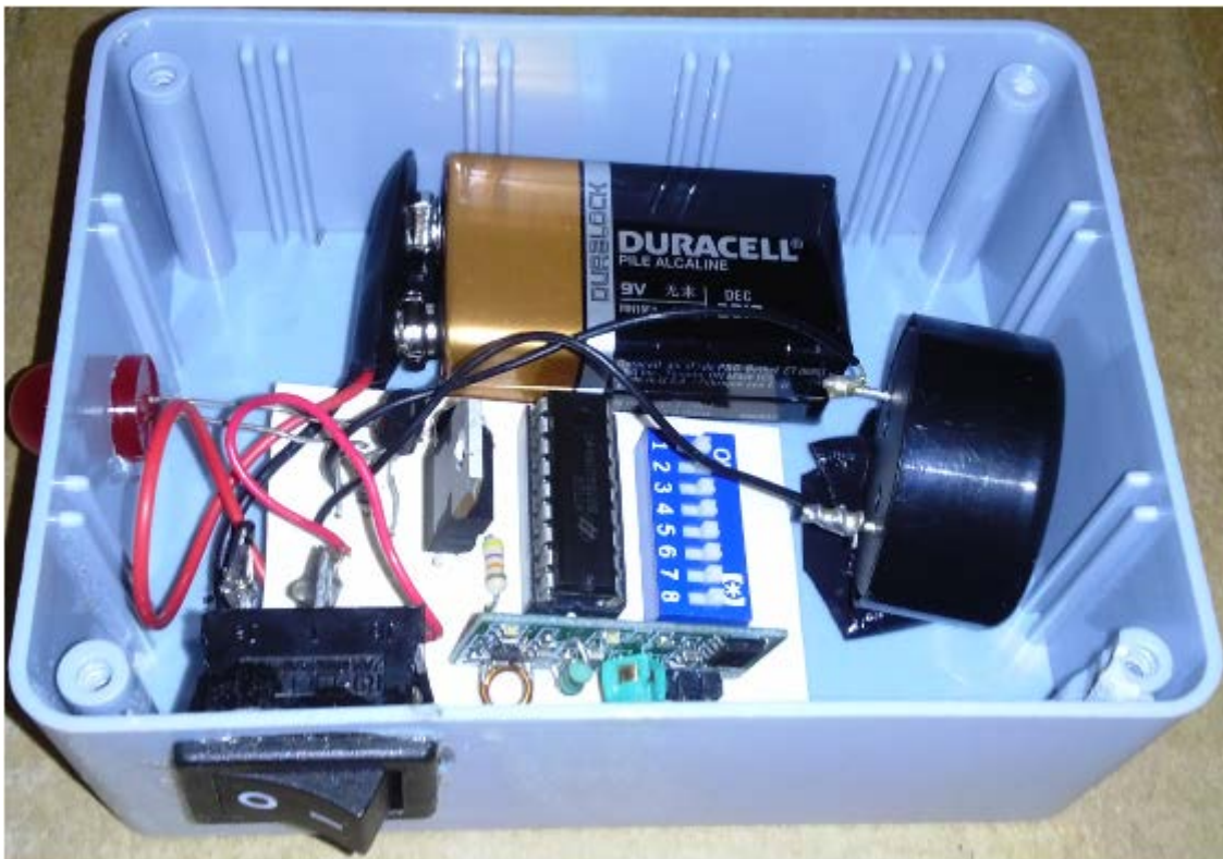
Figura 5.20. Vista interior de etapa de salida con componentes electrónicos soldados, montado sobre su gabinete plástico.
