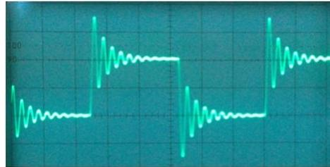
**Figura 2.10:** *Comportamiento dinámico del voltaje en un circuito RLC en serie.*
