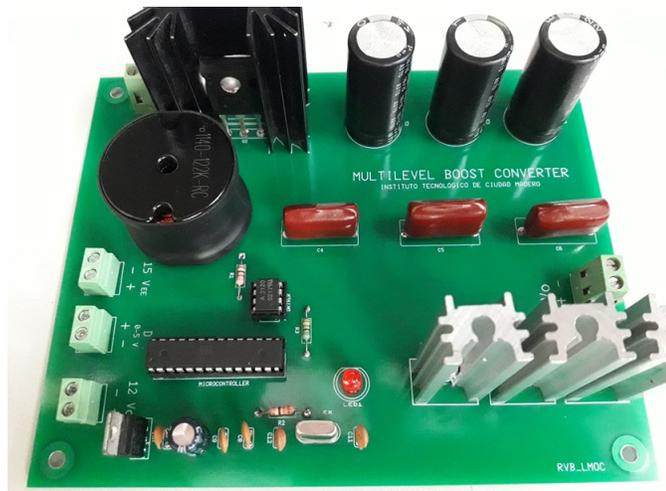
**Figura 3.8:** *Convertidor Boost Multinivel utilizado.*
