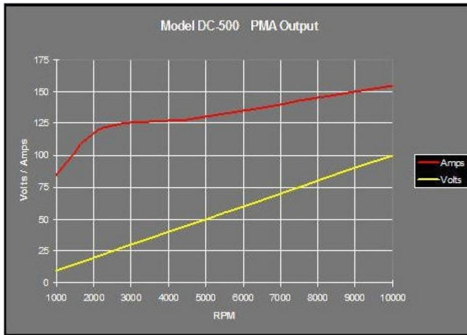
**Figura 2.17:** *Curvas de generación del PMSG.*
