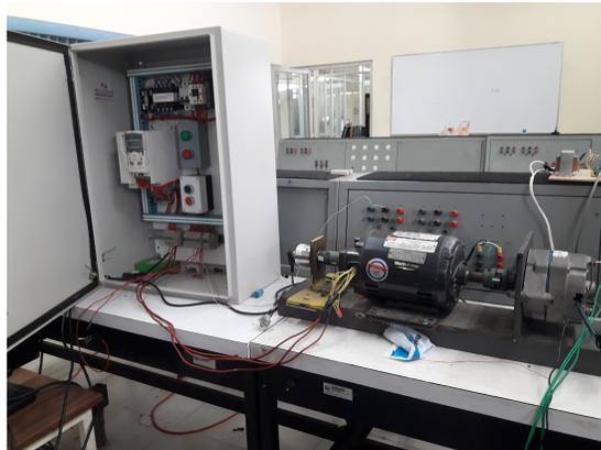
**Figura 5.7:** *Motor de inducción conectado al gabinete.*
