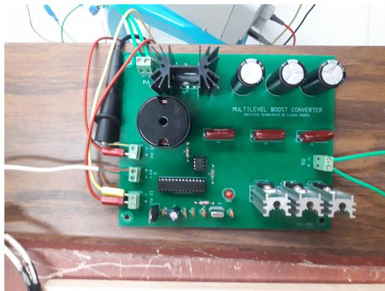
**Figura 5.10:** *MBC conectado al PMSG y al módulo inversor*
