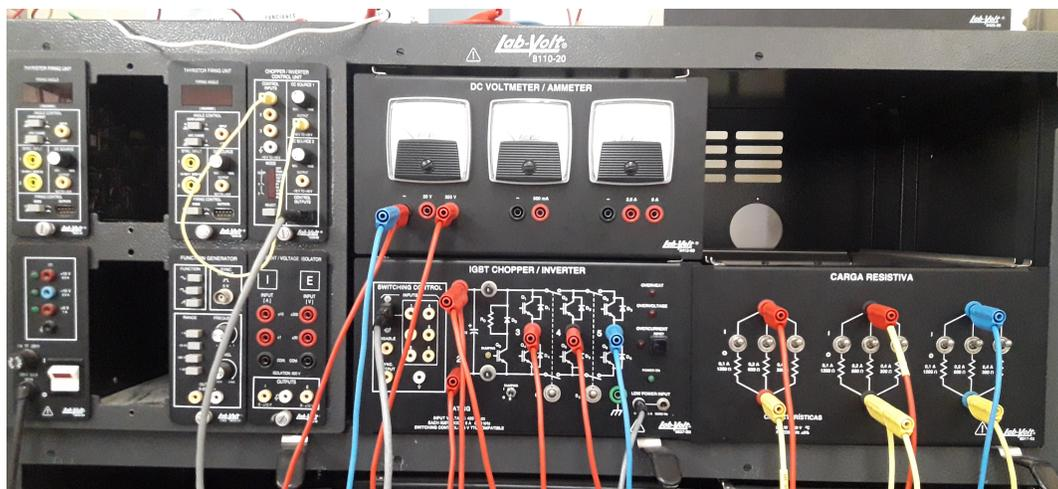
Figura 5.11: Conexión del módulo LAB-VOLT IGBT CHOPPER/INVERTER con la carga resistiva.
