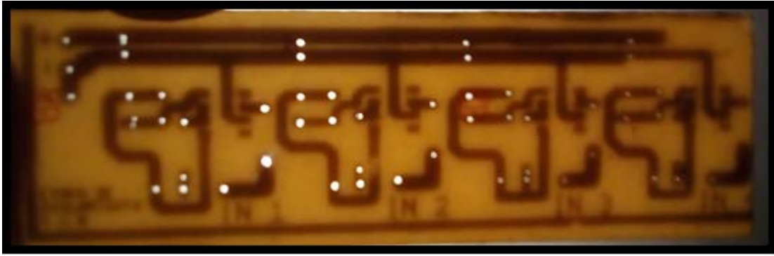
Figura 4.28.- Fotografía de circuito impreso vista superior visto en contra luz de la etapa de aislamiento.
