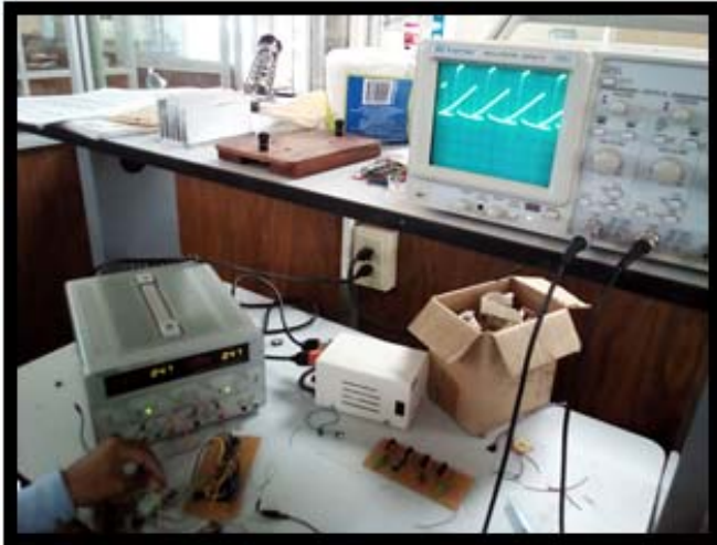
Figura 4.21.- Gráfica de la señal de control generada por el comparador/generador de 4 PWM con osciloscopio en pruebas realizadas en laboratorio, en esta ilustración las gráficas tiene un ciclo de trabajo D=24\%
