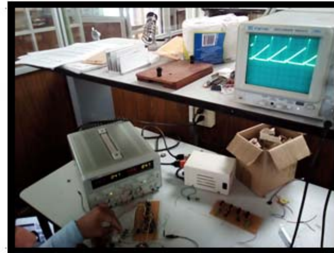
Figura 4.23.- Gráfica de la señal de control generada por el comparador/generador de 4 PWM con osciloscopio en pruebas realizadas en laboratorio, en esta ilustración las gráficas tienen un ciclo de trabajo D=10\% .
