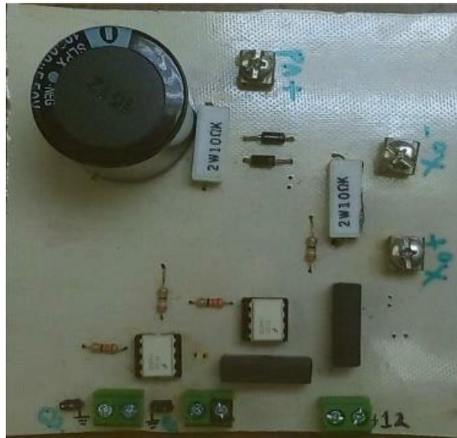
**Figura 3.10.** Vista superior de un prototipo de SM para un MMC. Pueden observarse los optoacopladores y los reguladores de voltaje en la parte inferior de la tarjeta.
