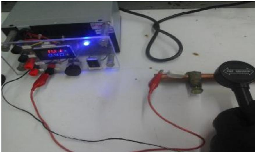
**Figura 4.17:** Fuente regulable inyectando voltaje de 10 volt y una corriente de 0.40 Amp.
