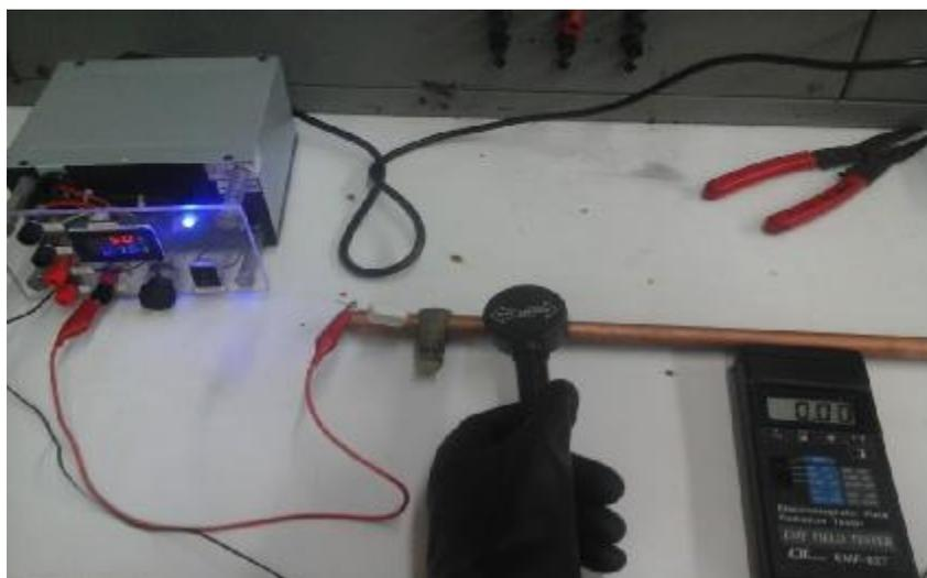
**Figura 4.16:** Visualización de presencia de campo magnético con EMF SENSOR
