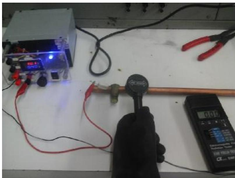
**Figura 4.18:** Observación de campo magnético con EMF SENSOR.
