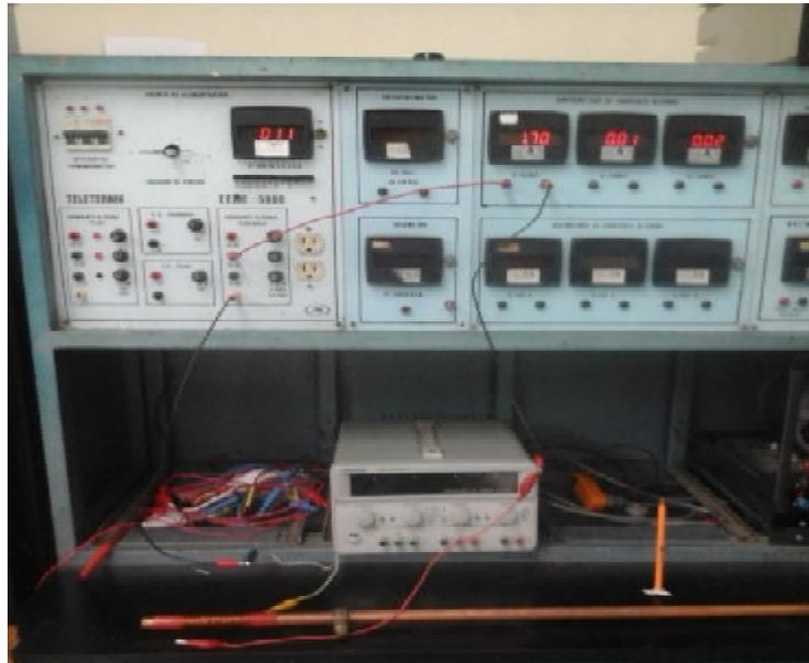
**Figura 4.20:** Conexión de la fuente variable CA.
