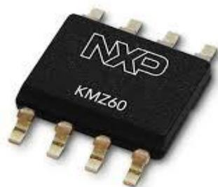
**Figura 4.5:** Sensor magneto-resistivo (kmz60).
