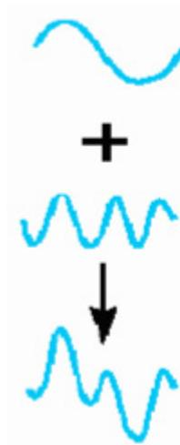
**Figura 2.5** Descomposición de una onda distorsionada.
