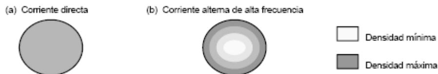
**Figura 2.7.** Densidades de corriente en un mismo conductor, (a) a corriente directa y (b) a corriente de alta frecuencia.
