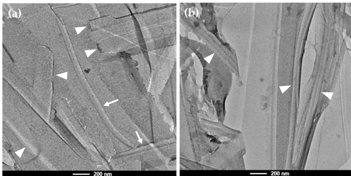
Figura 3.38 Micrografías FF-TEM del organogel OAM1-HEX-2 de diversas estructuras (a) formaciones lamelares y fibras aisladas, (b) conjuntos fibrilares.
