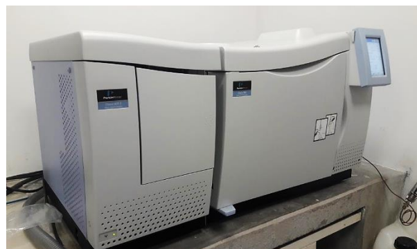
Figura 2.11 Equipo de cromatografía de gases acoplado a un espectrómetro de masas Perkin Elmer Clarus.
