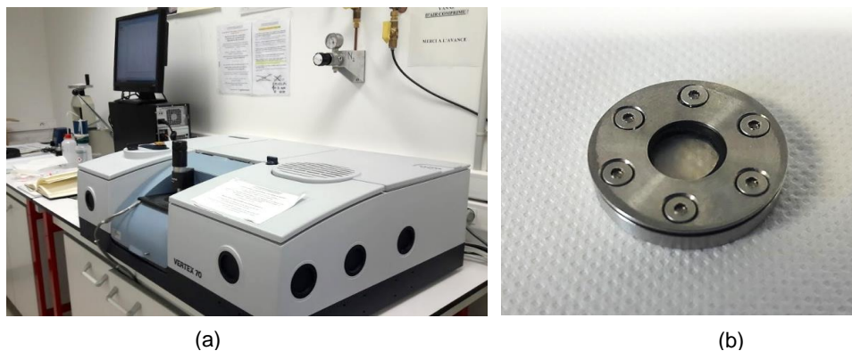
Figura 2.9 (a) Espectrofotómetro FTIR Bruker Vertex 70 (b) Muestra de gel insertada entre dos ventanas de KBr para realizar experimento de FTIR a temperatura variable.
