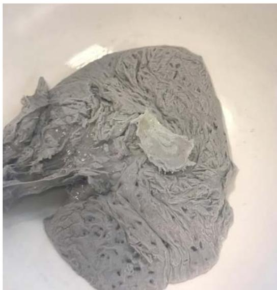
**Figura 2.2.** Nanopartículas de cobre incorporadas al PLA a través del diclorometano y el mezclado manual.
