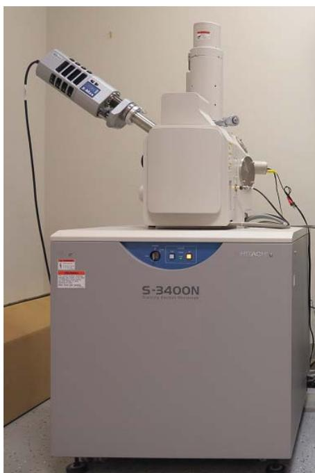
**Figura 2.12.** Microscopio de barrido electrónico Hitachi de presión variable S3400N.
