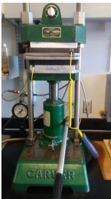
**Figura 2.9.** Prensa de calentamiento Carver, en la que fueron moldeados los minidisos para SEM y rectángulos para DMA.
