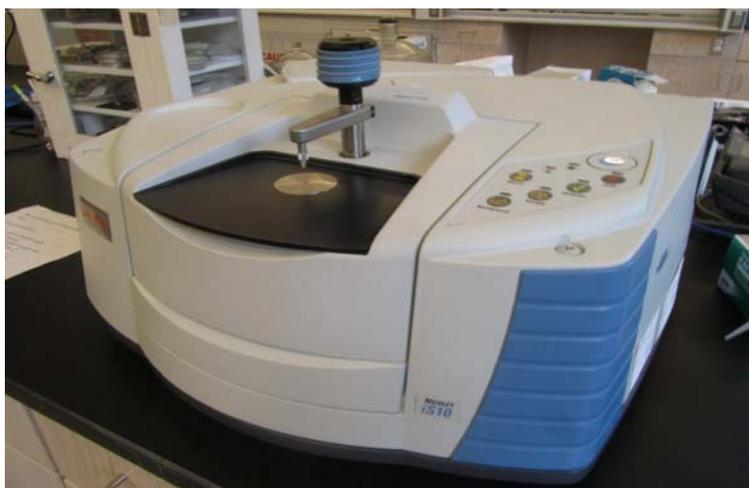
**Figura 2.6.** Espectrofotometro Thermo Scientific Nicolet iS10 FTIR con ATR.
