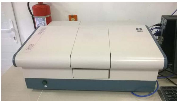
**Figura 2.3.** Espectrofotómetro UV-vis GBC modelo Cintra 303.
