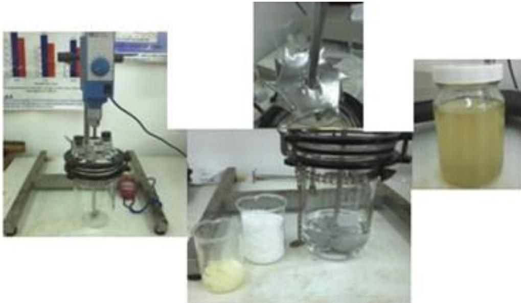
*Figura 2.1 Proceso de mezclado de mezcla adhesiva*
