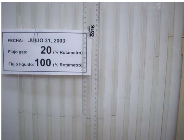
Figura A2.1. Fotografía de los niveles de líquido, la regla “T” y el rótulo.
