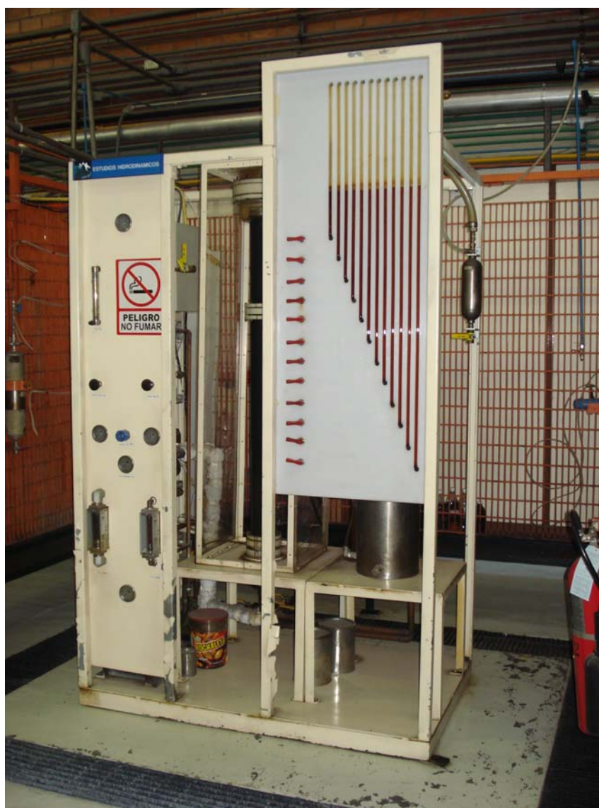
Figura 2.2. Planta de estudios hidrodinámicos de lecho ebullente [119]
