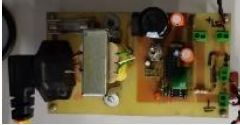
Figura 26. Circuito impulsor implementado.
