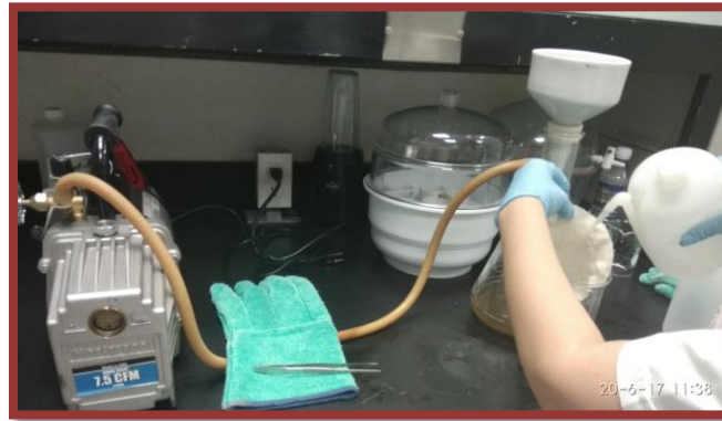
Figura 16. Bomba de vacío.
