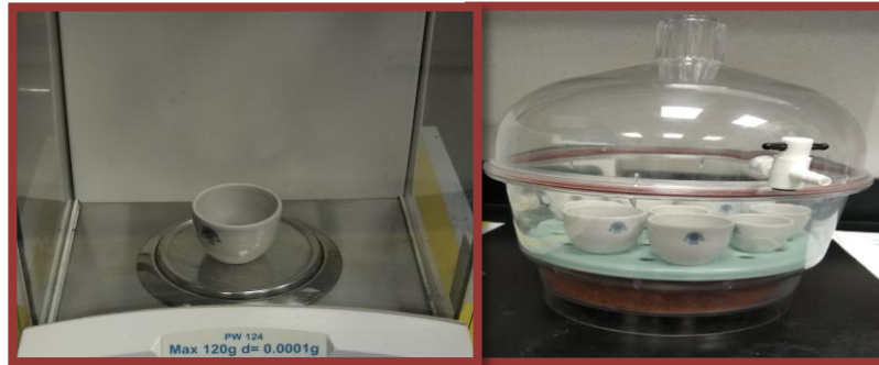
Figura 11. Crisol a peso constante se observa los 200 mg de muestra en el crisol a peso constante colocándolo en el secar durante 40 minutos para realizar el análisis de humedad
