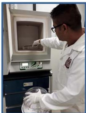
**Figura 13.** Determinación de cenizas. Incineración del filete de tilapia en una mufla a 600°C.
