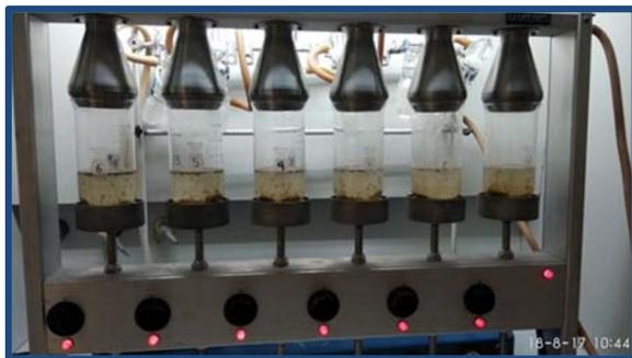
**Figura 12.** Determinación de fibra (método de hidrolisis ácida).
