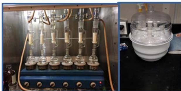
**Figura 11.** Extracción de lípidos (método soxhlet).
