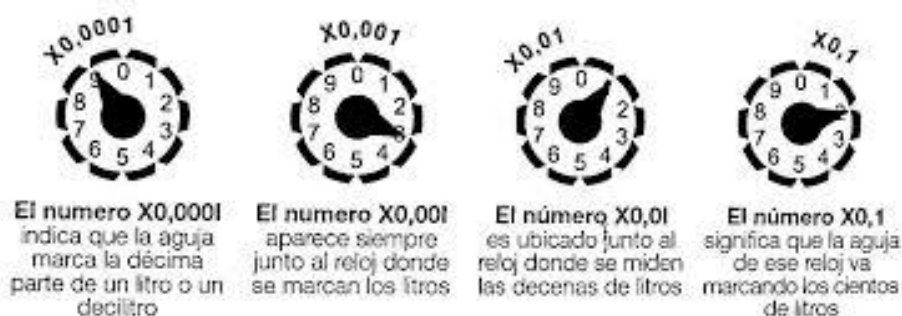
Ilustración 7 Agujas que integran un medidor de agua
