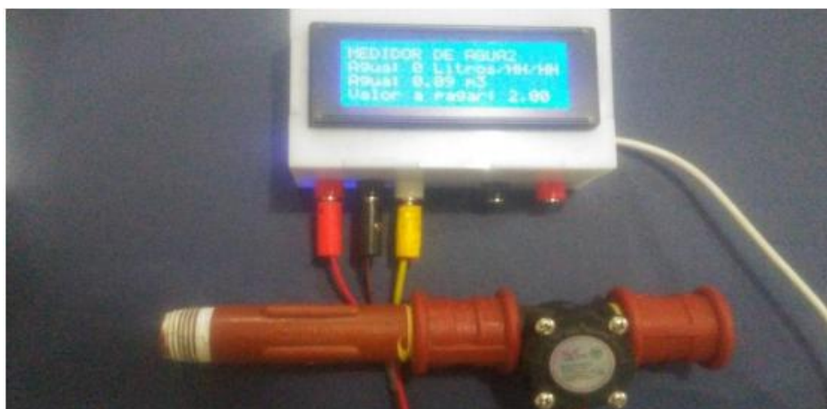
Ilustración 11 Medidor inteligente para la junta de agua "El Abra", conformado por todos los componentes
