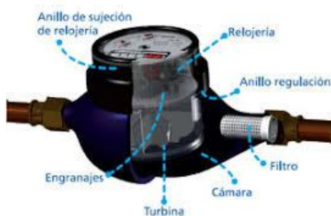
Ilustración 5 Proceso de un medidor convencional
