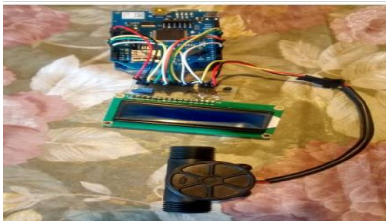
Ilustración 12 Medidor ensamblado para el monitoreo de agua en la ciudad de Quito
