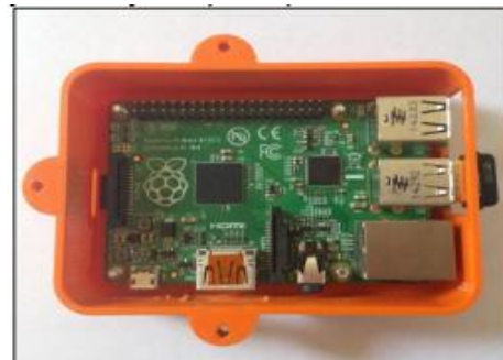
Ilustración 8 Raspberry ensamblada junto a la tarjeta de obtención de datos
