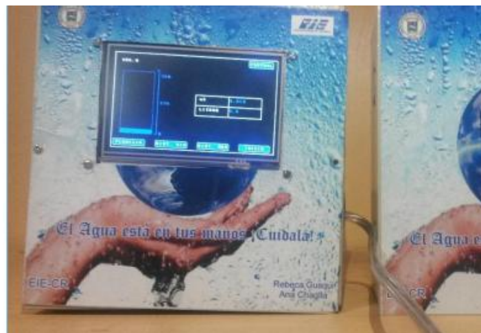
Ilustración 13 Dispositivo realizado para el control en el consumo de agua en la ciudad de Riobamba
