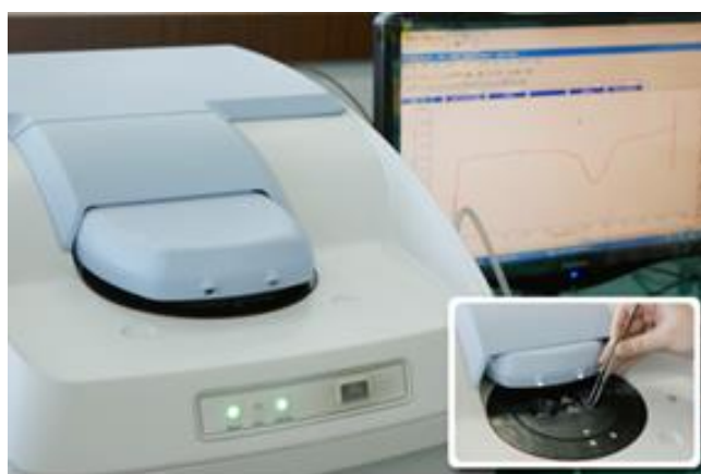
Figura 2.4 Calorímetro Diferencial de Barrido DSC 8000 de Perkin Elmer
