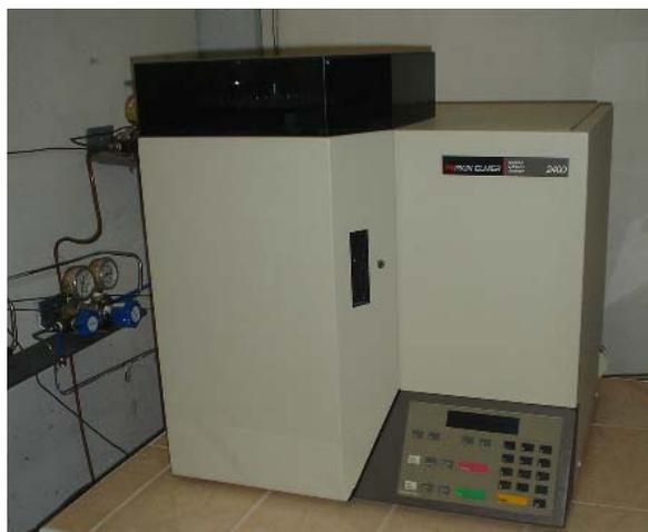
**Figura 2.6** Analizador elemental simultáneo marca Perkin Elmer 2400 Series II CHNS/O.
