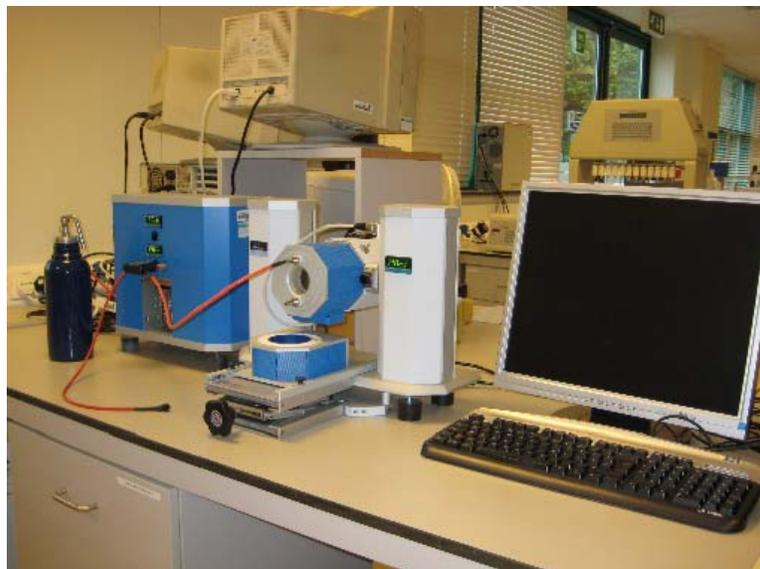
**Figura 2.9** Analizador Termomecánico Dinámico (DMTA) modelo MARC III Rheometric (polymer labs Loughborough, UK).
