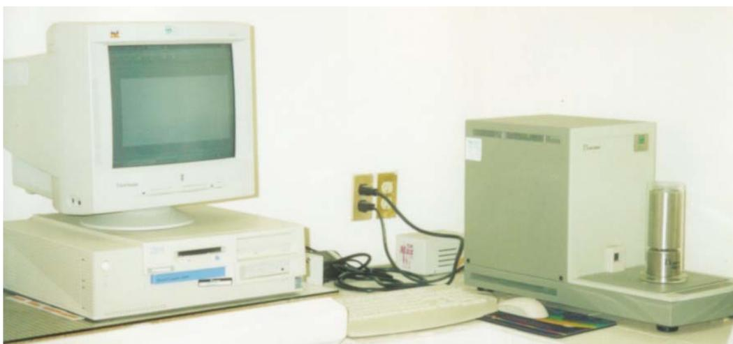
**Figura 2.5** Calorímetro Diferencial de Barrido marca TA Instruments.
