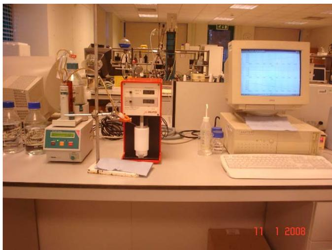
**Figura 2.8** Detector de la carga de la partícula marca Múteck modelo PCD-03 (pH).
