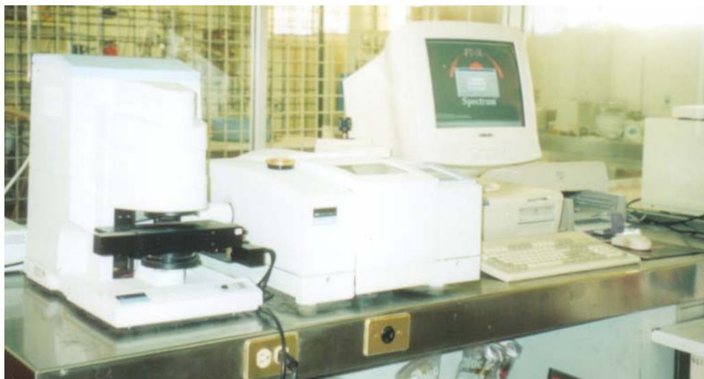
**Figura 2.4** Espectrofotómetro FTIR marca Perkin Elmer acoplado con estereomicroscópio modelo Spectrum One.
