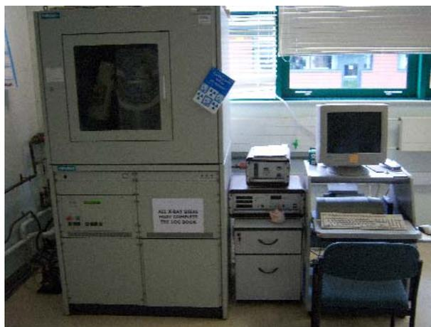
**Figura 2.7** Equipo de Difracción de Rayos X marca Siemens modelo D5005.
