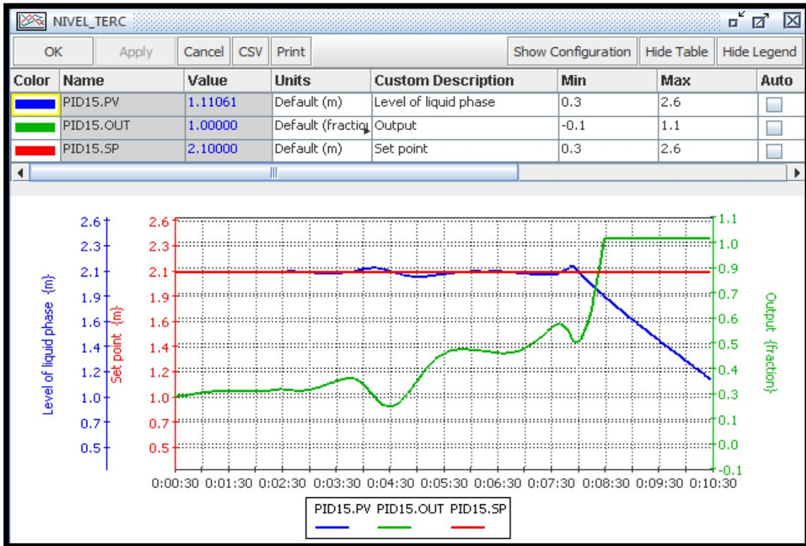
Figura 3.87. Respuesta del separador FA-201 a condición de muy bajo nivel en FA-101A.
