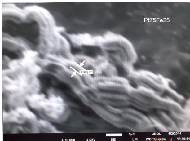
Figura 3.52. MEB a 10,000x de la morfología tipo “cuerdas” en el material Pt_{75}Fe_{25}/CMONS
