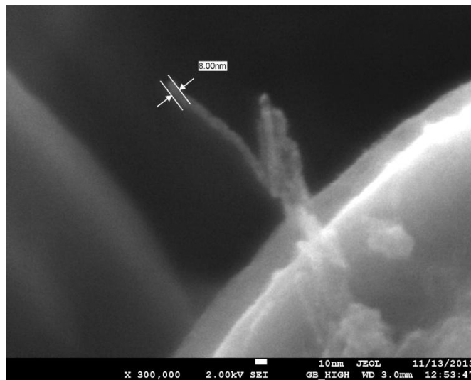
Figura 3.23. Diámetro aproximado del elemento cilíndrico del CMONS a 350,000x.
