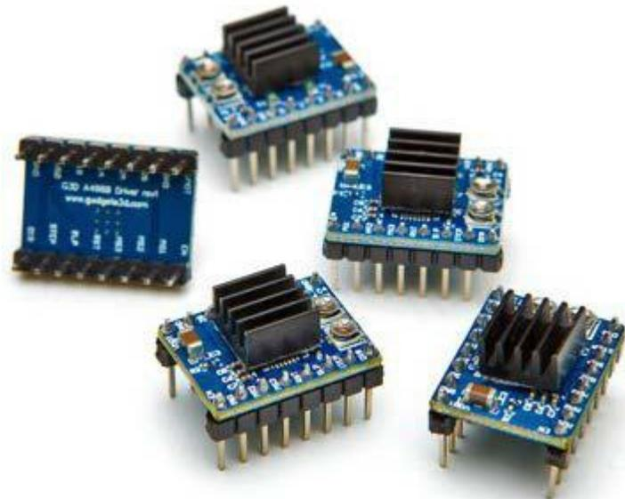
*Figura 2. 8 Controladores motores a paso A4988*
