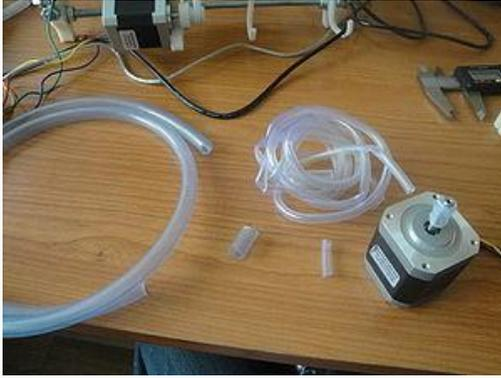
Figura 5. 95 Tubo de goma utilizado para poner el eje del motor
