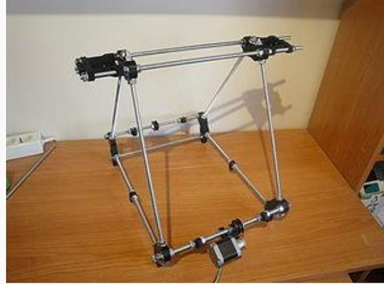
Figura 5. 82 Estado de la impresora, con la parte trasera y la parte superior
