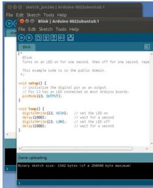
Figura 5. 9 Ejemplo "blink" descargado en el Arduino Mega
