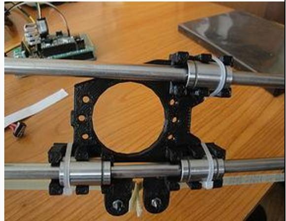
Figura 5. 55 Bridas para ajustar los rodamientos lineales del carro. Estas SI se aprietan
