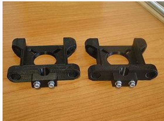
Figura 5. 70 Abrazaderas atornilladas a los soportes de los motores z mediante tornillos M3x20
