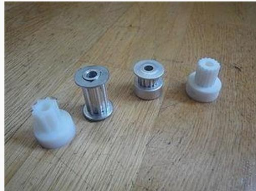
Figura 5. 42 4 Poleas: De izquierda a derecha: Polea T5 impresa, Polea T5 metálica, Polea 2.5 metálica y Polea 2.5 impresa.
