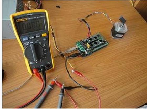
Figura 5. 28 Conexión para ajustar la corriente. El multímetro se pone en serie con el cable de 12V en modo amperímetro
