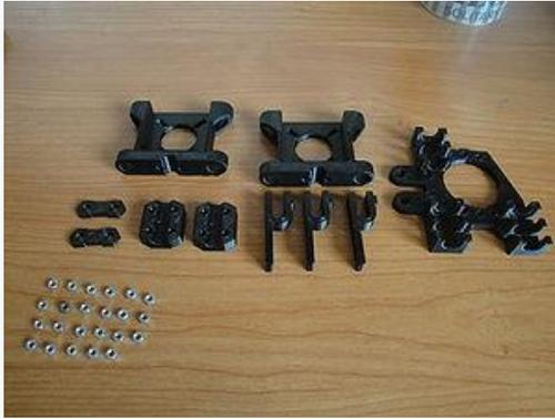
Figura 5. 44 Piezas que se deben modificar. 10 piezas. Se necesitan 23 tuercas M3
