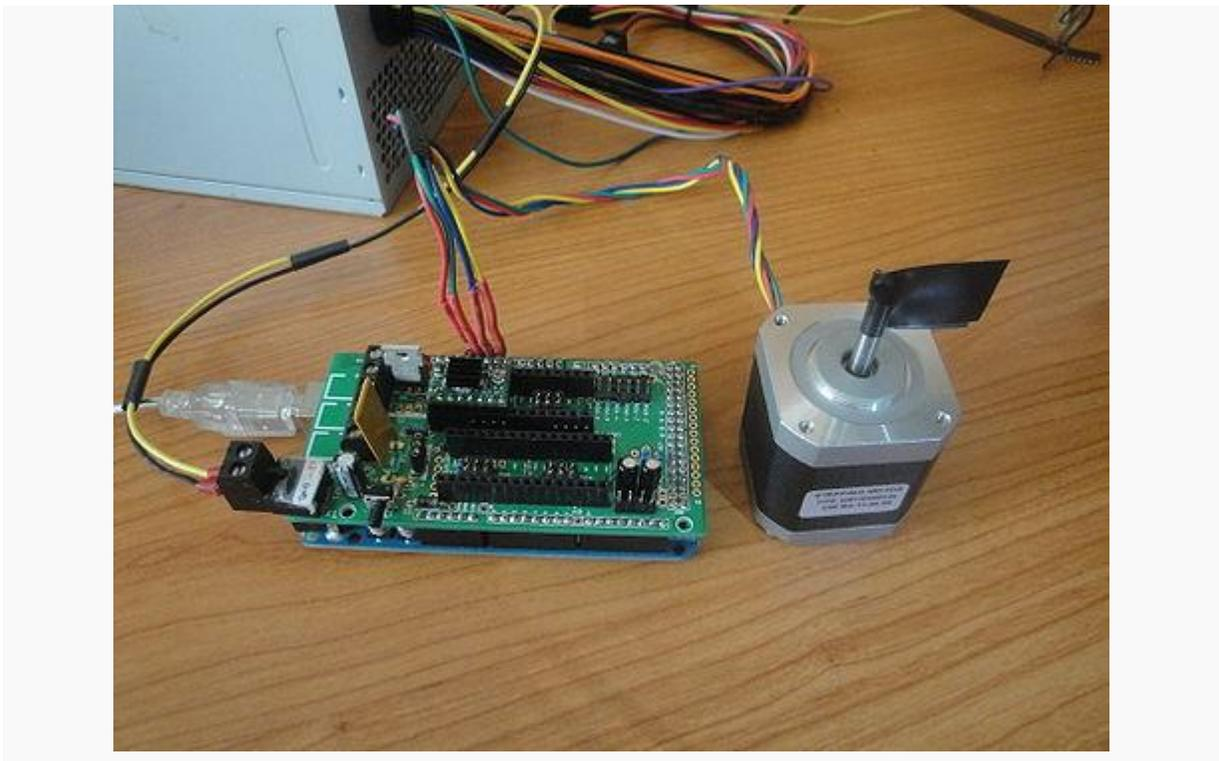
Figura 5. 26 Probando el motor paso a paso conectado al eje X.
