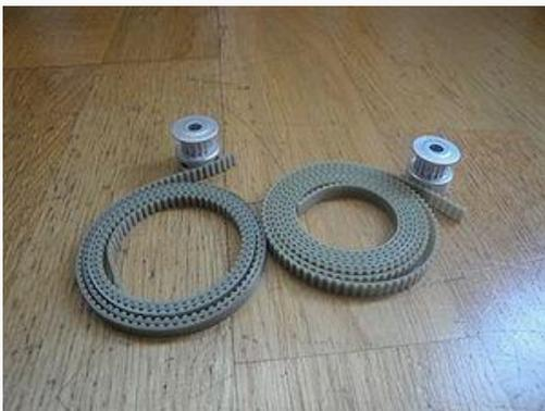
Figura 5. 43 2 poleas T2.5 metálicas y dos correas T2.5. Es lo que usaremos en la construcción de nuestra impresora.
