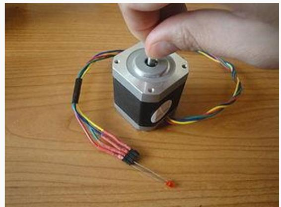
Figura 5. 25 Comprobando las conexiones con la prueba del "led".
