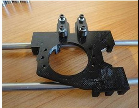
Figura 5. 50 Carro del eje x montado
