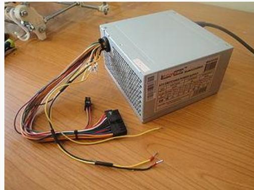
Figura 5. 15 Fuente de alimentación lista para usarse con la RAMPS
