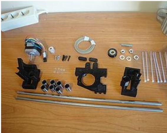
Figura 5. 49 Todas las piezas necesarias para el montaje del eje x
