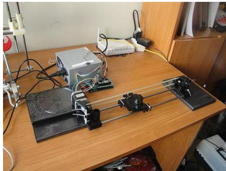
Figura 5. 61 Probando el eje x. Está conectado a la Ramps 1.2 y el carro se mueve desde el Pronterface.
