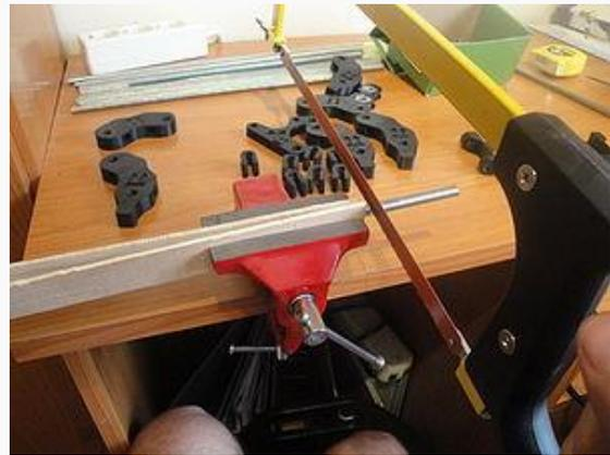
Figura 5. 68 Cortando una varilla roscada
