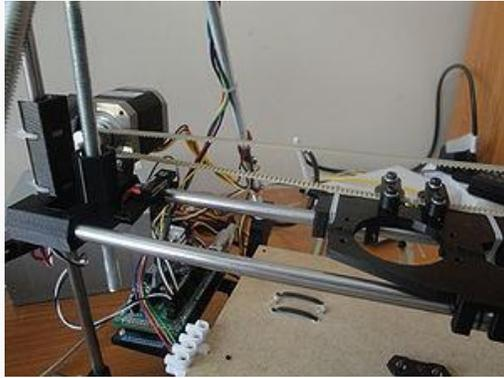
Figura 5. 109 Final del carrera del eje "x"
