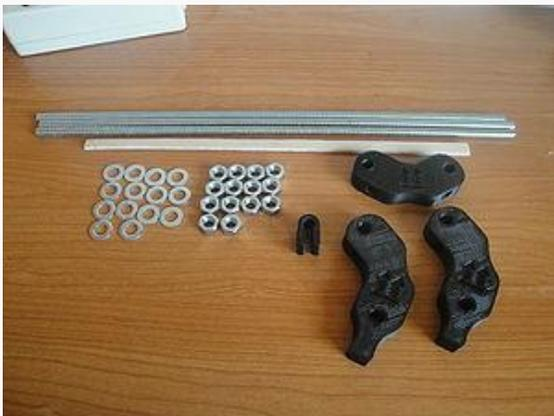
Figura 5. 71 Piezas necesarias para montar un triángulo lateral.
