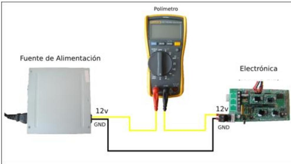
Figura 5. 29 Esquema de conexión del multímetro para ajustar la corriente de los motores.
