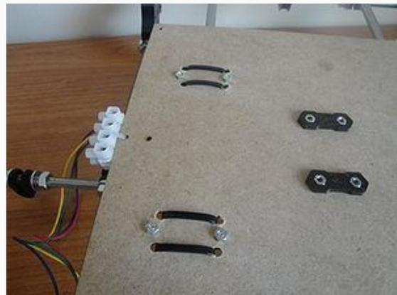
Figura 5. 89 Detalle de las bridas para los rodamientos y las clemas
