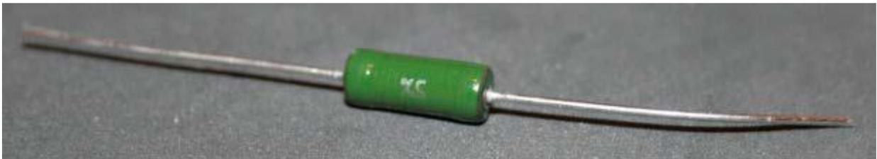
*Figura 2. 10 Resistencia calorífica 6R8 2.5W*
