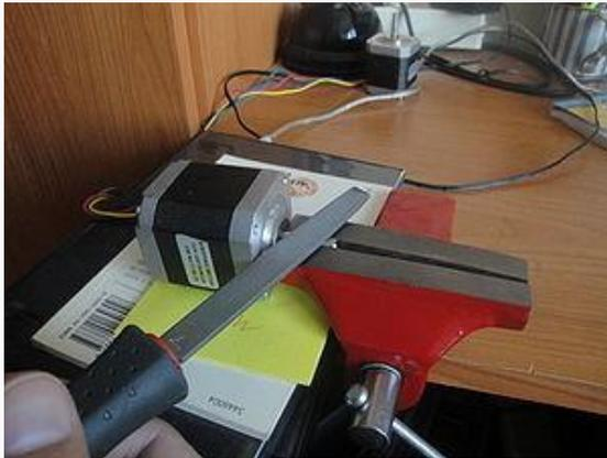
Figura 5. 39 Aplanando el eje del motor. Necesario un tornillo de banco y una lima para metal
