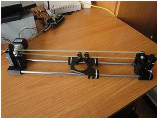
Figura 5. 56 Vista frontal del Eje x terminado
