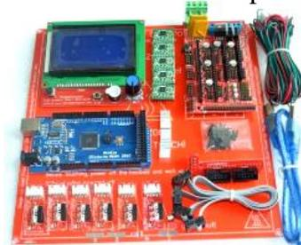
Figura 3. 3 Placa Madre, Arduino, RAMPS conectados
