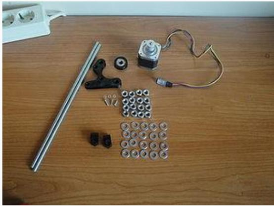
Figura 5. 77 Piezas necesarias para montar el frontal
