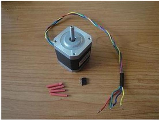
Figura 5. 22 Motor a paso Nema 17, tira de 4 pines hembra y 4 tozos de termorretractil de 1.5cm.
