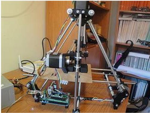
Figura 5. 107 Vista lateral de los motores cableados y conectados a la electrónica.
