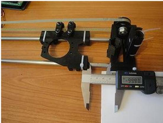
Figura 5. 64 Mover el carro 100 mm a la derecha y tomar lectura con el vernier
