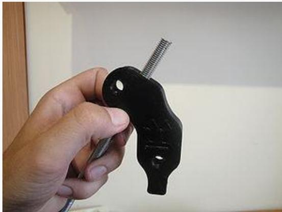
Figura 5. 69 Comprobación de que la varilla roscada entra en los barrenos de las piezas
