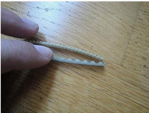
Figura 5. 41 Comparación entre las correas T5 y T2.5.
