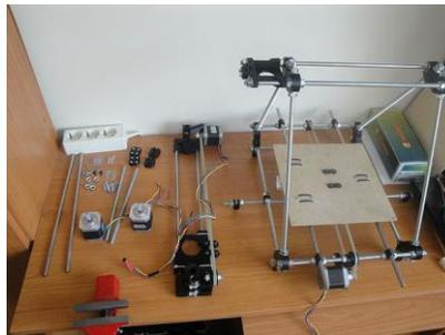
Figura 5. 94 Piezas necesarias para montar el eje "z"
