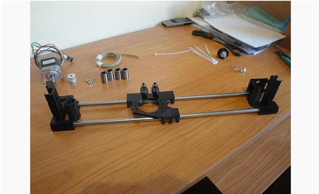
Figura 5. 51 Carro Montado sobre varillas lisas
