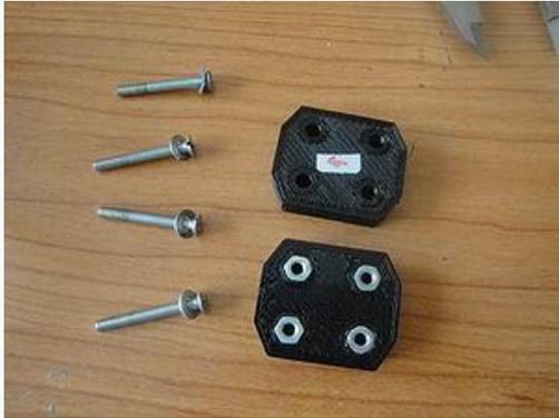
Figura 5. 99 Parte posterior de los acoples. Poner una marcha en la parte donde está el cilindro de diámetro pequeño, donde se coloca el eje del motor
