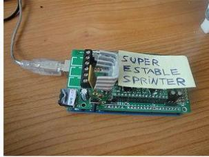
Figura 5. 11 RAMPS 1.4 con el firmware Sprinter (súper estable) cargado. Lista para conectarse al PC
