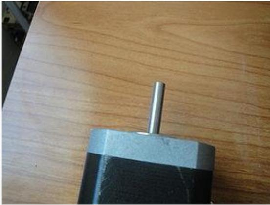
Figura 5. 37 Eje original del motor. Es de sección circular
