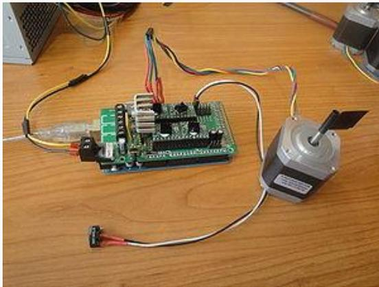
Figura 5. 33 Final de carrera del eje x siendo probado.
