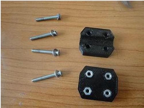
Figura 5. 97 Acoples para los motores del eje
