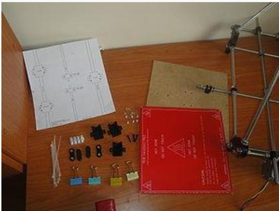
Figura 5. 86 Piezas necesarias para montar la base del eje "y"
