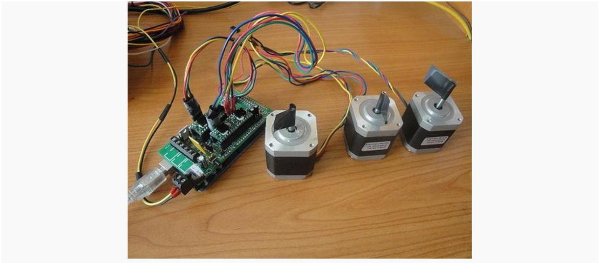
Figura 5. 30 Los tres motores conectados a la RAMPS
