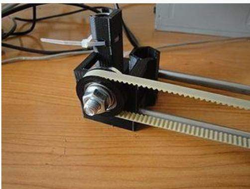
Figura 5. 58 Detalle de la polea
