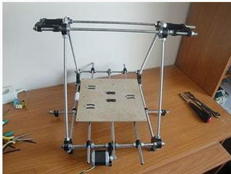
Figura 5. 90 La impresora con el eje "y" terminado
