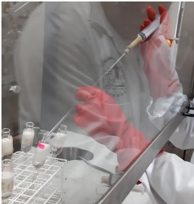
Figura 7. Adición de ácido sulfúrico concentrado al 91 % a la muestra de yogurt para la determinación de grasa por el método de Gerber.
