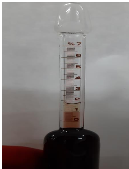
Figura 8. Resultado final de la determinación de grasa en el butirómetro de la muestra de yogurt aplanado de pectina de tempesquistle con gellan.
