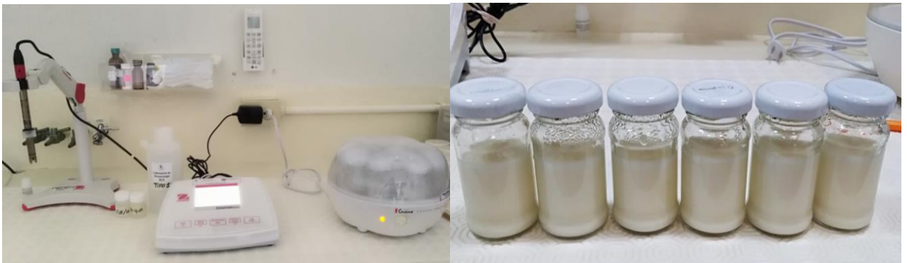
Figura 3. Monitoreo del pH para evaluar la evolución del proceso de fermentación.
