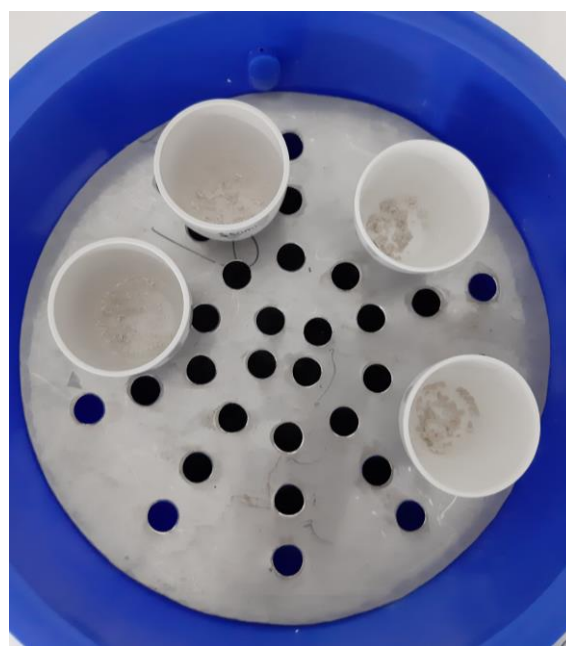
Figura 6. Muestra de yogurt después de la calcinación en mufla a 550 °C.
