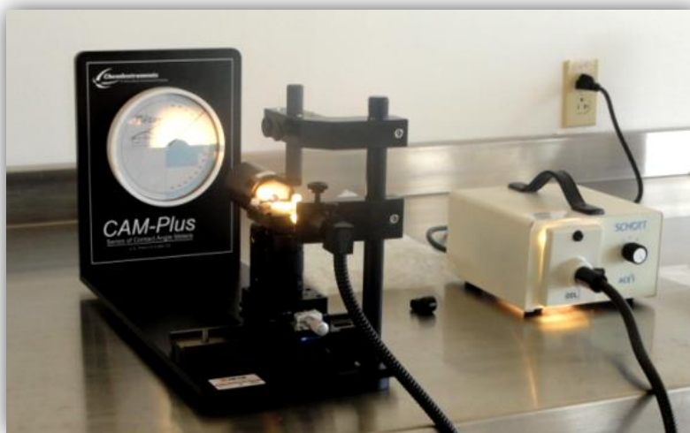
Figura A1.6. Ángulo de contacto, CAM-plus, ChemInstruments.
