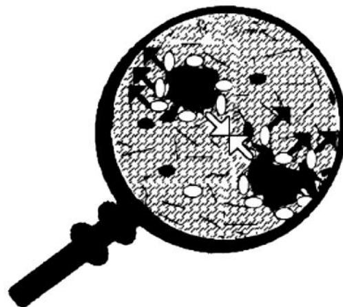
Figura 1.10. Migración de resinas de la superficie de los asfaltenos.
