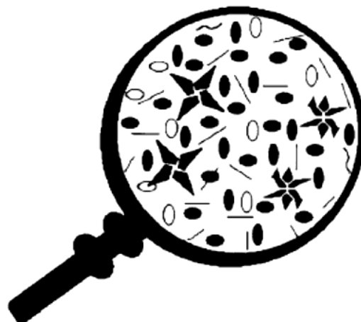
Figura 1.7. Fenómeno de agregación coloidal debido al incremento en la concentración de un solvente polar miscible (aromático).
