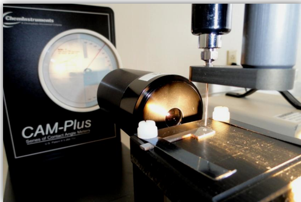
Figura 3.48. Medición de ángulo de contacto de una gota de agua con AC-1018 S/T.
