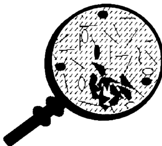
Figura 1.8. Floculación y precipitación de asfaltenos debido a la adición de un solvente no polar (parafina).
