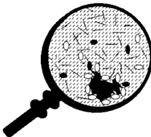
Figura 1.9. Fenómeno estérico coloidal debido al incremento en la concentración de parafinas.
