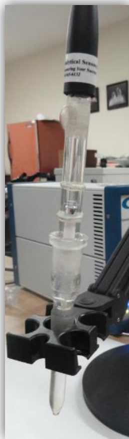
Figura 2.3. Electrodo de referencia.
