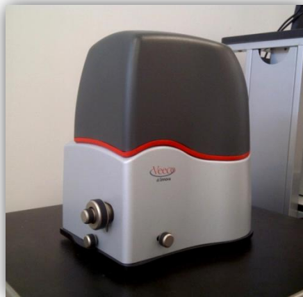
Figura A1.2. Microscopio de fuerza atómica, Veeco di Innova, Bruker.
