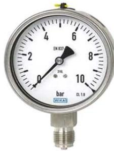
Figura 2.9 Manómetro tipo tubo de bourdon para aplicaciones industriales.
