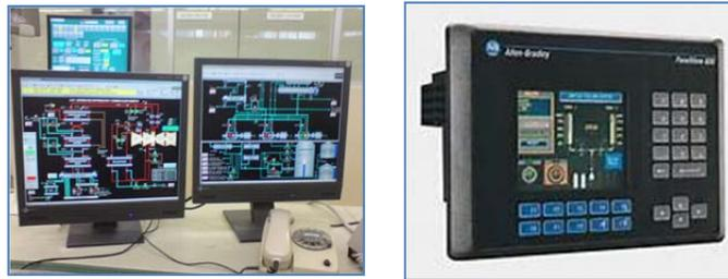
Fig. 2.35. PC y Panel View desempeñan la función de un HMI en un proceso de producción.
