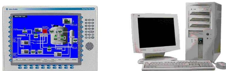
Fig. 2.41. El interfaz hombre-máquina (HMI) en una planta o proceso, puede ser mediante una PC o Panel View.
