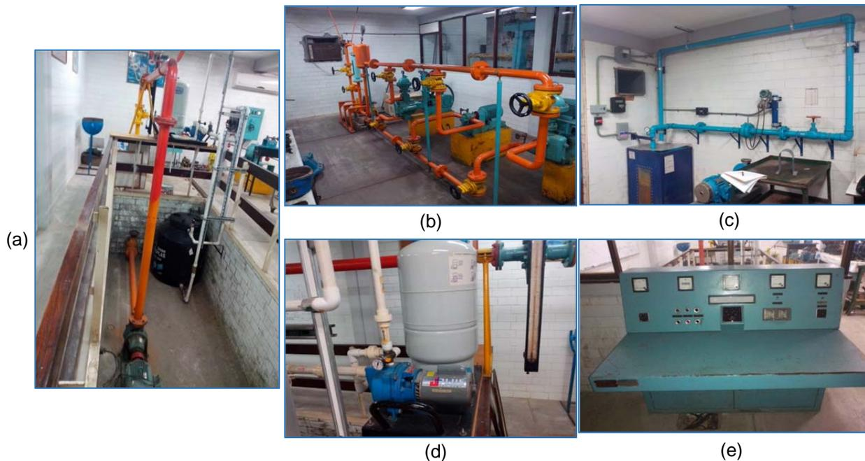
Fig. 1.1. Equipos que conforman el cuarto de bombas del laboratorio de Ingeniería Mecánica del laboratorio del ITCM. (a) Bomba centrífuga horizontal. (b) Bomba de pistón, bomba de engranes y bomba de membrana (c) Bomba vertical de pozo profundo (d) Tanque hidroneumático (e) Tablero de control de bombas.
