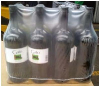
Fig 2. 19 Envasado en film termocontraible
