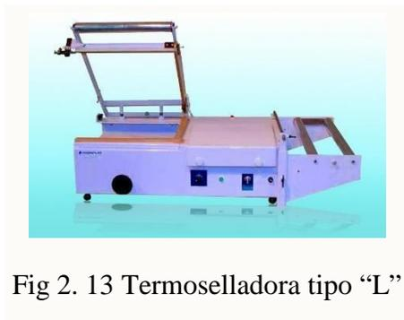
Fig 2. 13 Termoselladora tipo “L”
