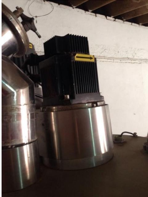
Fig 2. 28 Motor eléctrico dispuesto para el funcionamiento de la mezcladora.
