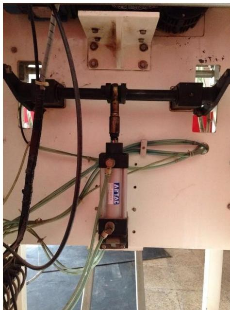
Fig 2. 33 Actuator neumático.
