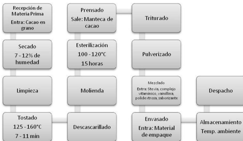
Fig 2. 4 Diagrama tecnológico del proceso de producción del chocolate en polvo.
