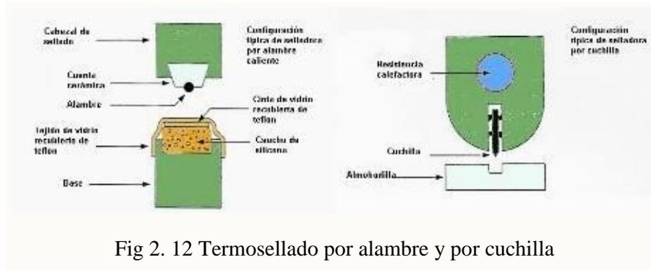
Fig 2. 12 Termosellado por alambre y por cuchilla
