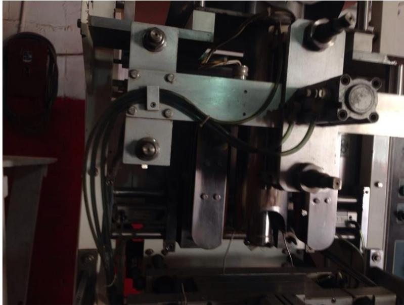
Fig 2. 36 Pistón de activación para el sellador vertical.
