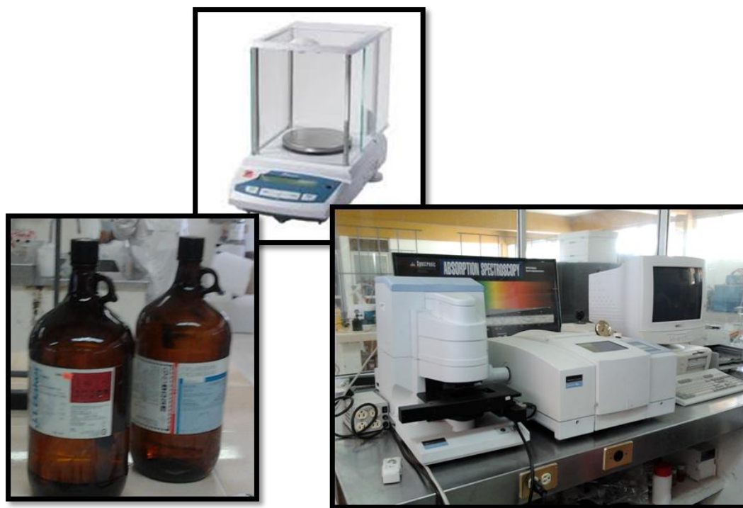
Figura 2.1. Ejemplos de material y equipo (disolventes y Espectrofotómetro FTIR).
