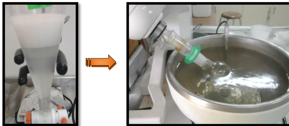
Figura 2.3. Separación y recuperación del derivado fenólico.
