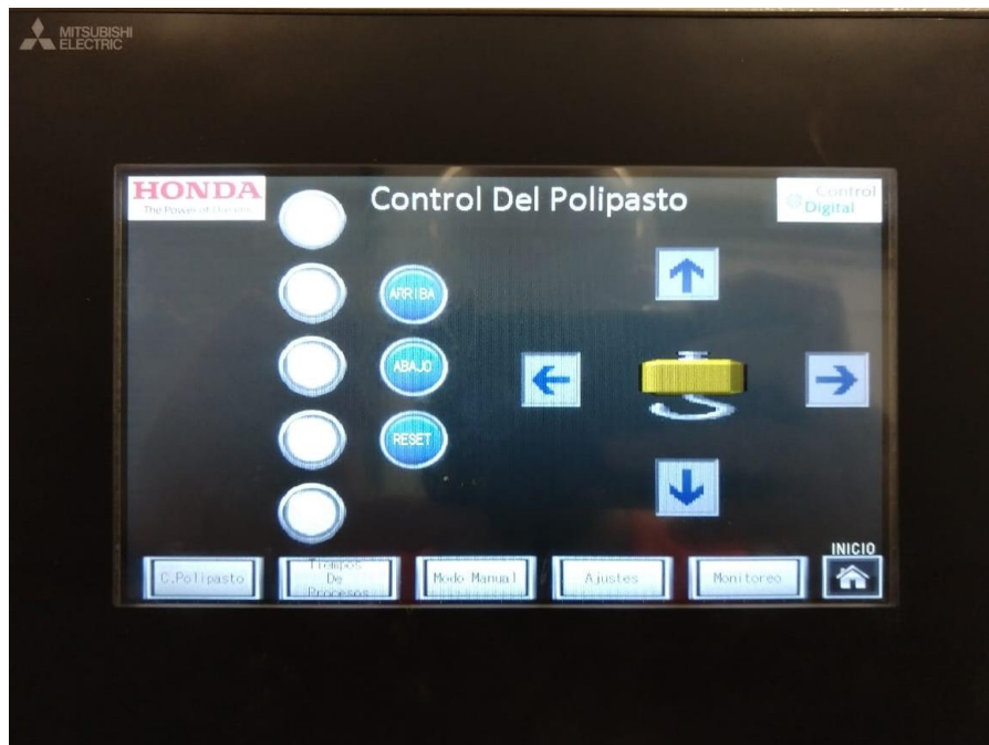
Figura 60. Pantalla control del polipasto.
