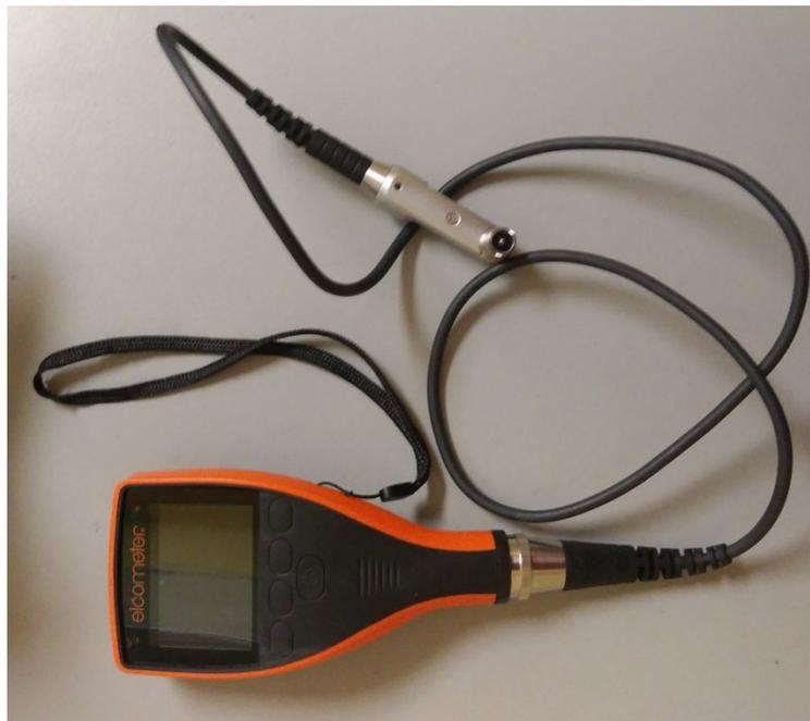
Ilustración 8 Medidor de espesores
