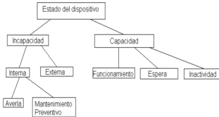
Imagen 2.4 Esquema de capacidad de los dispositivos
