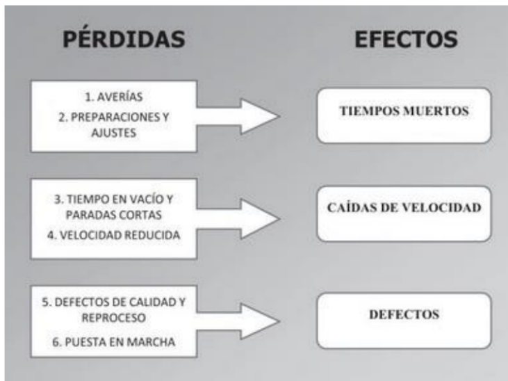
Imagen 2.10 Seis pérdidas de los equipos de producción
