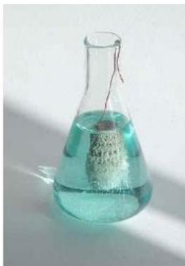
Plata metálica depositada sobre un alambre de cobre.
