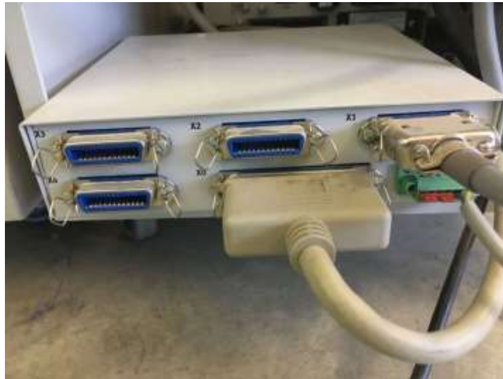
Figura 15-40 Paso 7 Conexión del cable el cable Centronics de la unidad de interface del robot Festo 8046131 a la unidad de conexión universal digital SysLink Festo 162231
