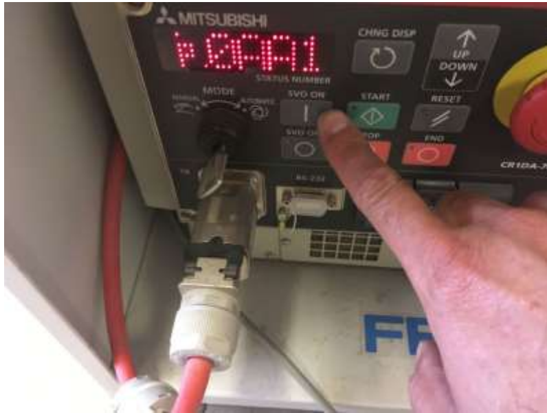
Figura 14-46. Paso 7. Encender los servos utilizando el botón SVO ON en el controlador.
