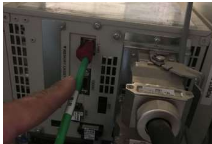
Figura 13-17. Paso 4. Conecte un extremo de un cable patch cord ethernet al puerto LAN del controlador del robot.
