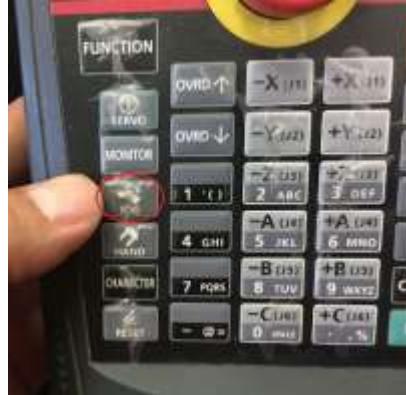
Figura 11-27 Paso 5. Activación de modo JOG.
