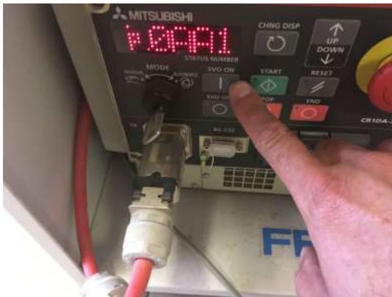
Figura 11-46. Paso 7. Encender los servos utilizando el botón SVO ON en el controlador.
