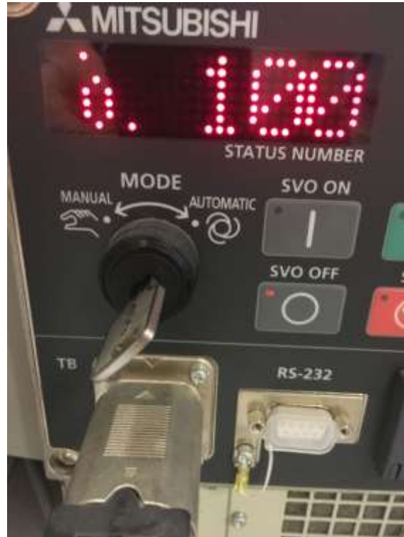
Figura 11-41. Paso 7. LLAVE DE MODO en la posición AUTOMATIC
