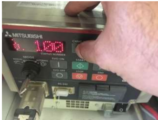
Figura 12-43. Paso 7. Botón CHANGE DISPLAY en el controlador para buscar MODO "P" para correr el programa.
