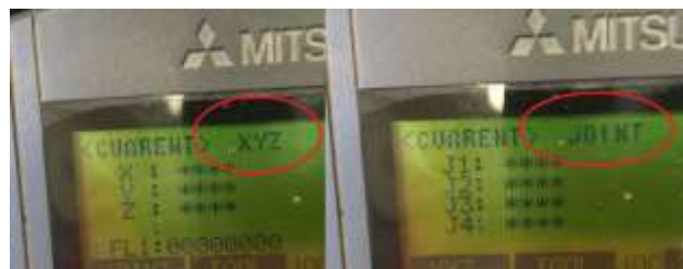
Figura 11-28. Paso 5. Selección y verificación de modo JOG.
