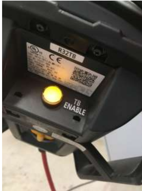
Figura 11-25. Paso 5. TB ENABLE del TEACH PENDANT encendido.
