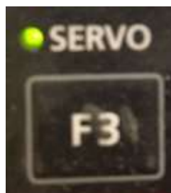
Figura 12-30. Paso 5. LED de confirmación de encendido de servomotores, en el TEACH PENDANT
