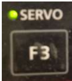
Figura 11-30. Paso 5. LED de confirmación de encendido de servomotores, en el TEACH PENDANT
