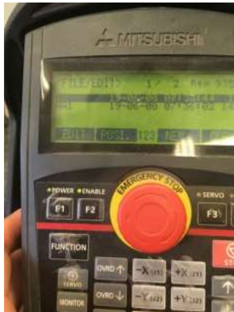
Figura 11-36. Paso 6. Selección de F1 (opción EDIT) para dar TEACH a las posiciones.
