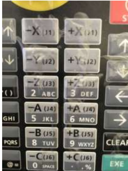
Figura 12-31. Paso 5. Teclas para JOGEAR el robot. En el TEACH PENDANT.
