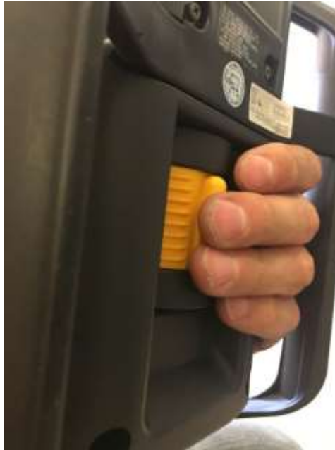
Figura 12-26. Paso 5. Activación de DEAD MAN SWITCH detrás del TEACH PENDANT.
