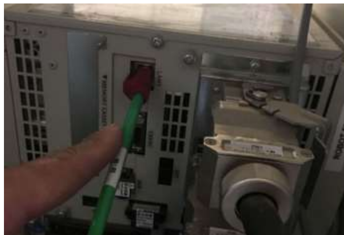
Figura 14-17. Paso 4. Conecte un extremo de un cable patch cord ethernet al puerto LAN del controlador del robot.
