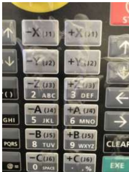
Figura 11-31. Paso 5. Teclas para JOGEAR el robot. En el TEACH PENDANT.
