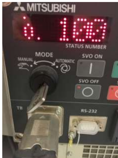
Figura 14-41. Paso 7. LLAVE DE MODO en la posición AUTOMATIC
