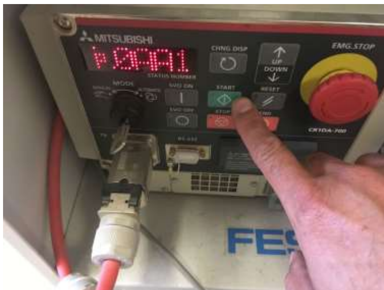
Figura 11-48. Paso 7. Al oprimir el botón verde START, se empezará a correr la rutina.
