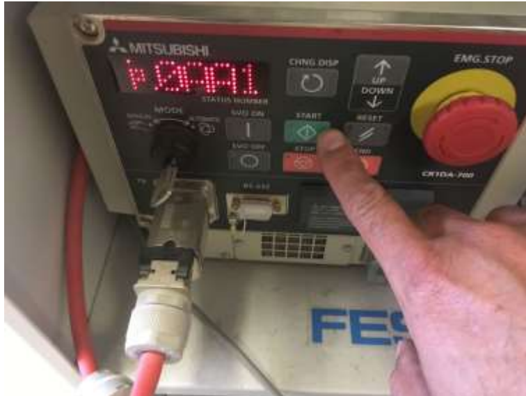
Figura 14-48. Paso 7. Al oprimir el botón verde START, se empezará a correr la rutina.
