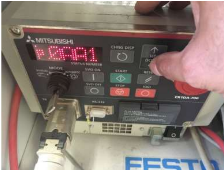
Figura 12-45. Paso 7. Uso de flechas UP DOWN en el controlador en MODO "P" para buscar el programa a ejecutar.
