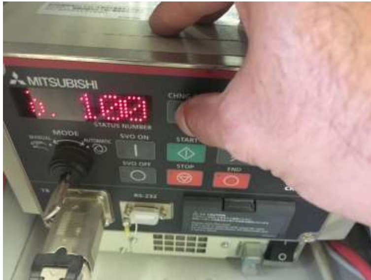
Figura 13-43. Paso 7. Botón CHANGE DISPLAY en el controlador para buscar MODO "P" para correr el programa.
