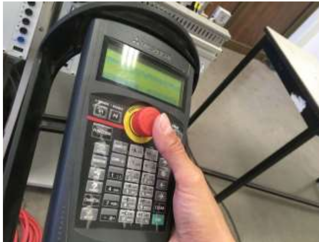
Figura 13-47. Paso 7. Tener listo el paro de emergencia para cualquier eventualidad.
