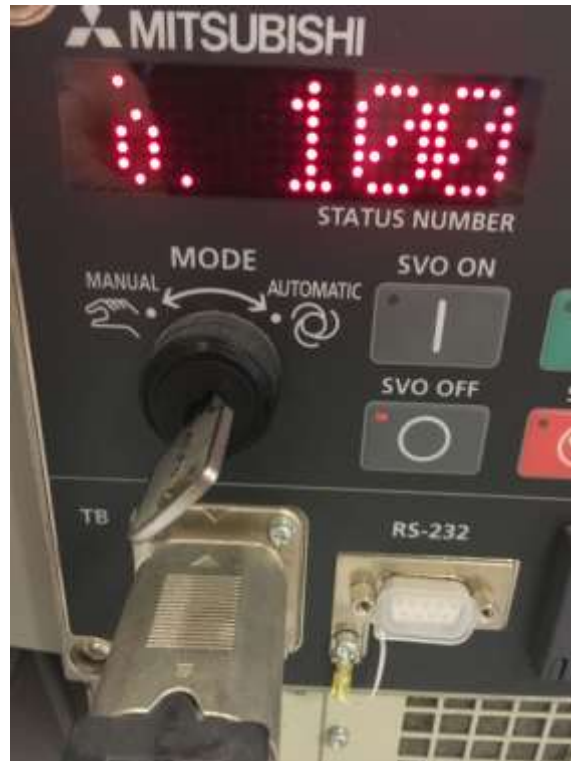
Figura 15-47. Paso 8. LLAVE DE MODO en la posición AUTOMATIC
