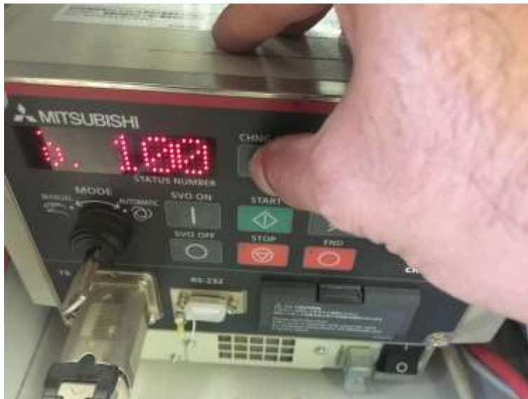
Figura 14-43. Paso 7. Botón CHANGE DISPLAY en el controlador para buscar MODO "P" para correr el programa.
