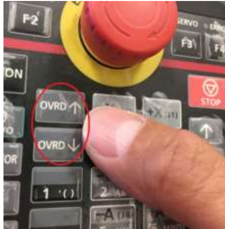
Figura 11-32. Paso 5. Teclas para subir y bajar la velocidad del robot. En el TEACH PENDANT
