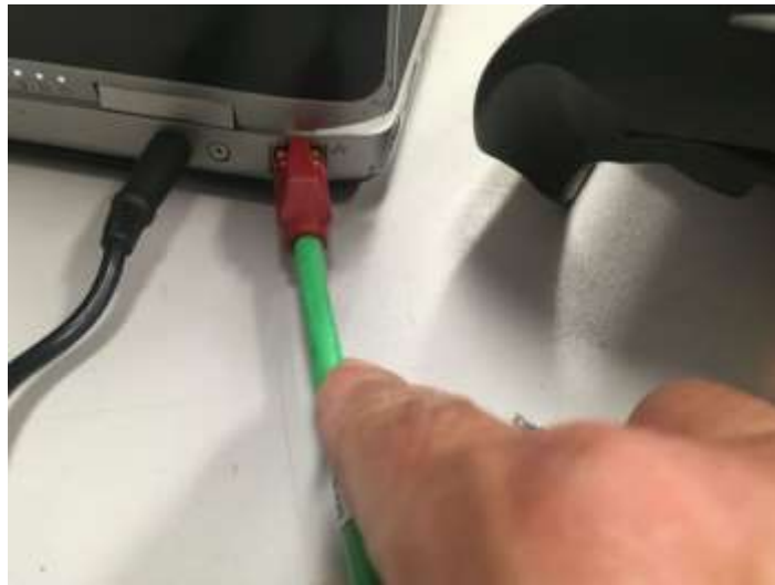
Figura 13-16. Paso 4. Conecte un extremo de un cable patch cord ethernet a la tarjeta de red del equipo de cómputo con Ciros instalado.
