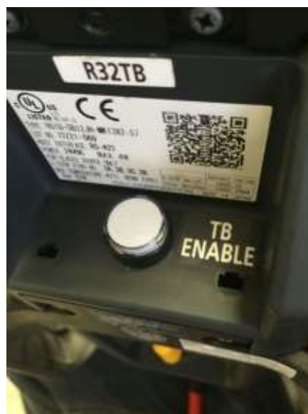
Figura 11-40 Paso 7. Botón TB ENABLE apagado al reverso del TEACH PENDANT.
