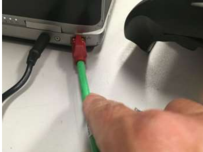
Figura 12-16. Paso 4. Conecte un extremo de un cable patch cord ethernet a la tarjeta de red del equipo de cómputo con Ciros instalado.
