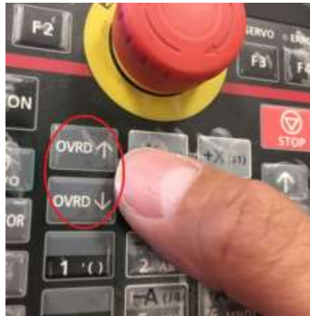
Figura 14-32. Paso 5. Teclas para subir y bajar la velocidad del robot. En el TEACH PENDANT
