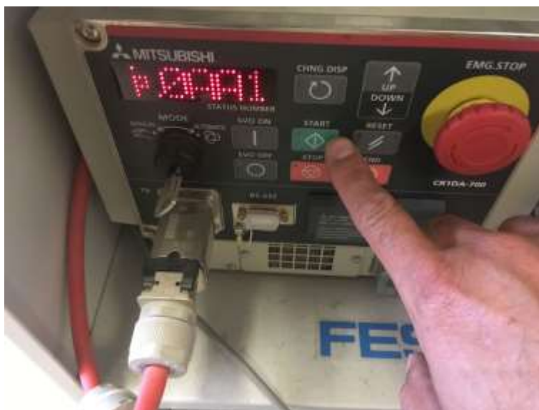
Figura 13-48. Paso 7. Al oprimir el botón verde START, se empezará a correr la rutina.
