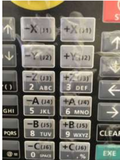
Figura 14-31. Paso 5. Teclas para JOGEAR el robot. En el TEACH PENDANT.
