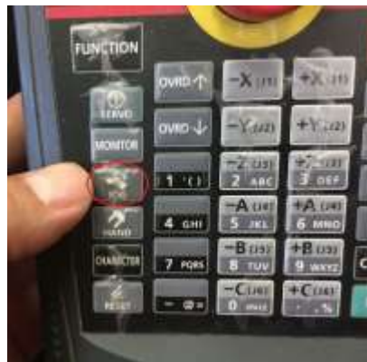
Figura 12-27 Paso 5. Activación de modo JOG.
