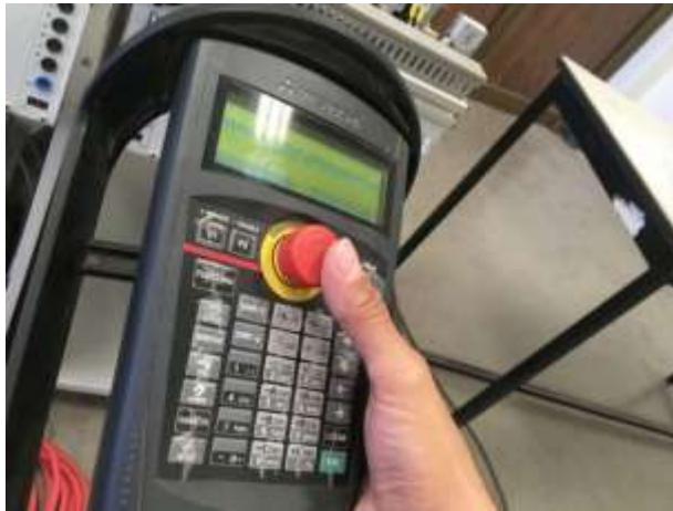
Figura 15-53. Paso 8. Tener listo el paro de emergencia para cualquier eventualidad.
