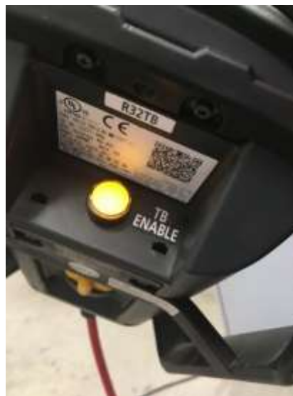
Figura 15-33. Paso 6. TEACH PENDANT encendido.
