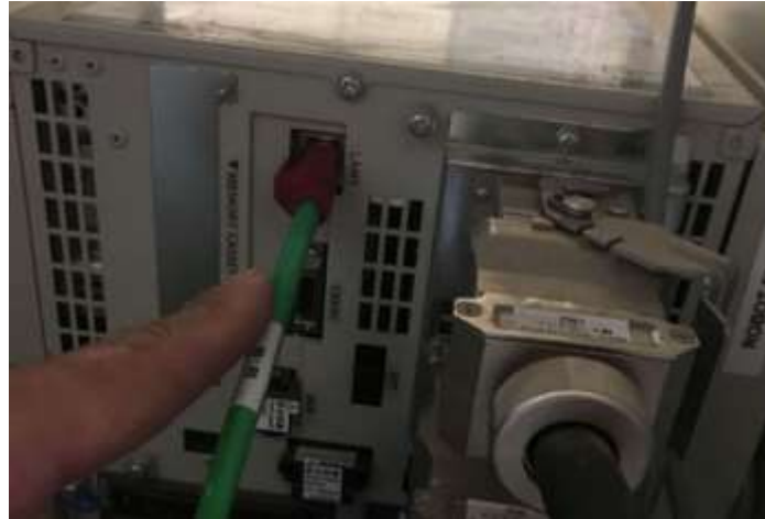
Figura 11-17. Paso 4. Conecte un extremo de un cable patch cord ethernet al puerto LAN del controlador del robot.
