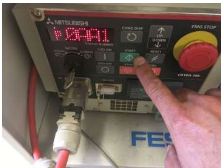
Figura 15-54. Paso 8. Al oprimir el botón verde START, se empezará a correr la rutina.
