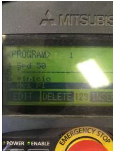
Figura 13-37 Paso 6. Selección de renglón donde aparece P1 usando las flechas del TEACH PENDANT.
