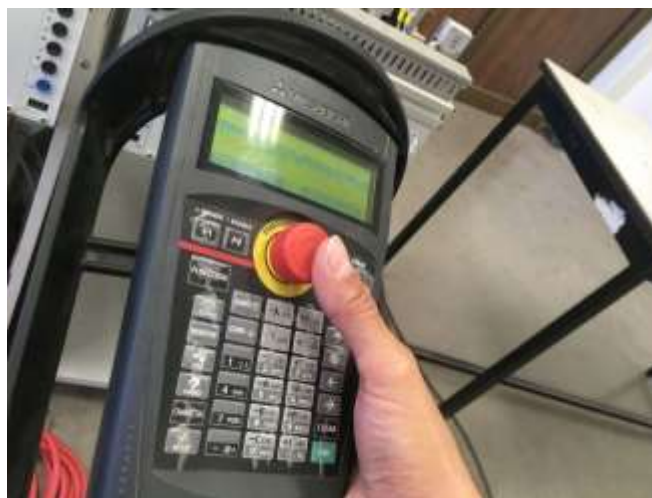
Figura 14-47. Paso 7. Tener listo el paro de emergencia para cualquier eventualidad.
