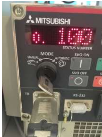
Figura 11-33. Paso 6. LLAVE DE MODO en la posición MANUAL
