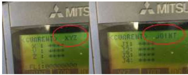
Figura 14-28. Paso 5. Selección y verificación de modo JOG.
