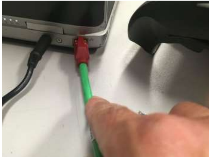
Figura 15-15. Paso 4. Conecte un extremo de un cable patch cord ethernet a la tarjeta de red del equipo de cómputo con Ciros instalado.
