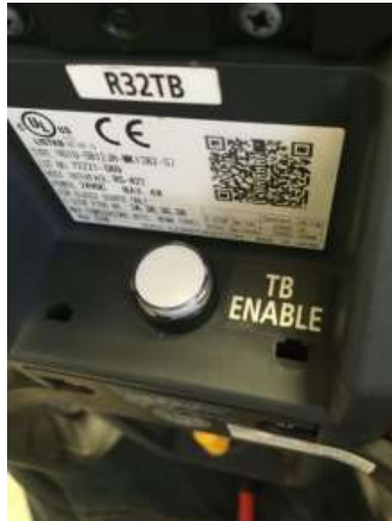
Figura 12-40 Paso 7. Botón TB ENABLE apagado al reverso del TEACH PENDANT.
