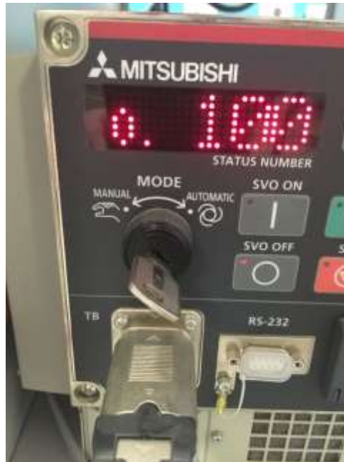
Figura 12-24. Paso 5. LLAVE DE MODO en el controlador en posición MODO MANUAL.
