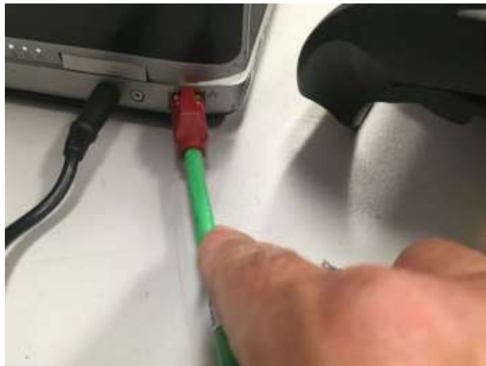
Figura 11-16. Paso 4. Conecte un extremo de un cable patch cord ethernet a la tarjeta de red del equipo de cómputo con Ciros instalado.
