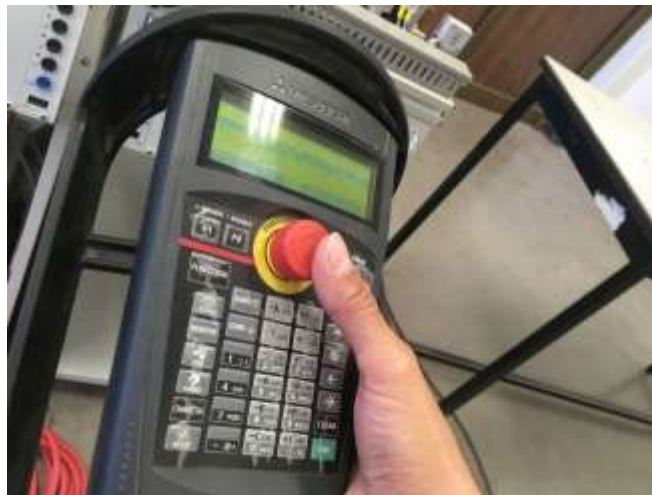
Figura 12-47. Paso 7. Tener listo el paro de emergencia para cualquier eventualidad.
