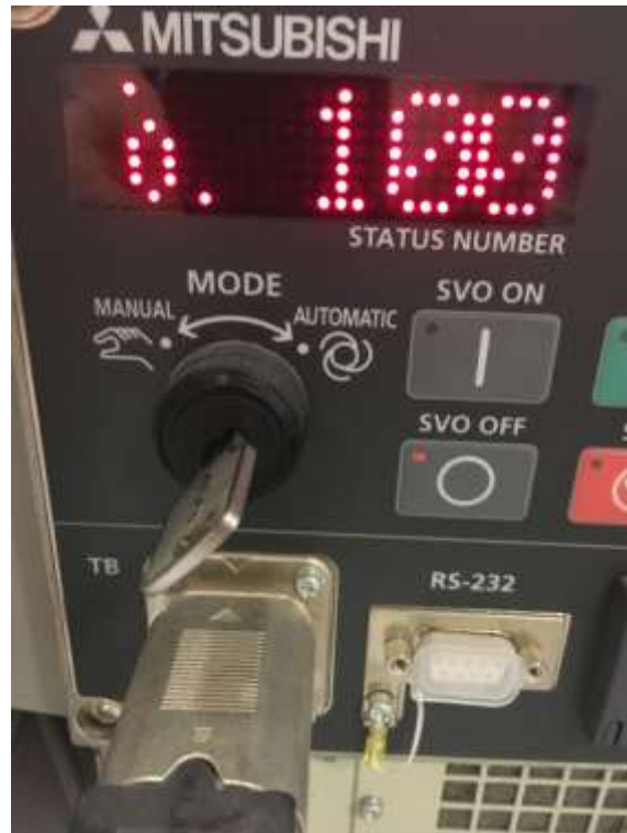
Figura 13-41. Paso 7. LLAVE DE MODO en la posición AUTOMATIC
