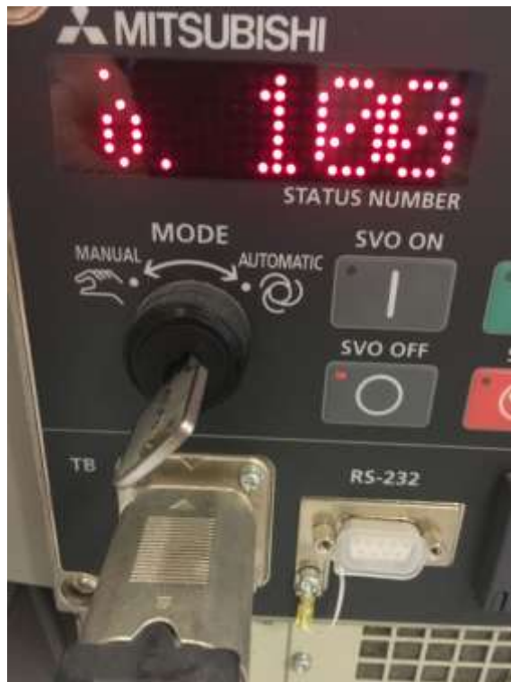
Figura 12-41. Paso 7. LLAVE DE MODO en la posición AUTOMATIC
