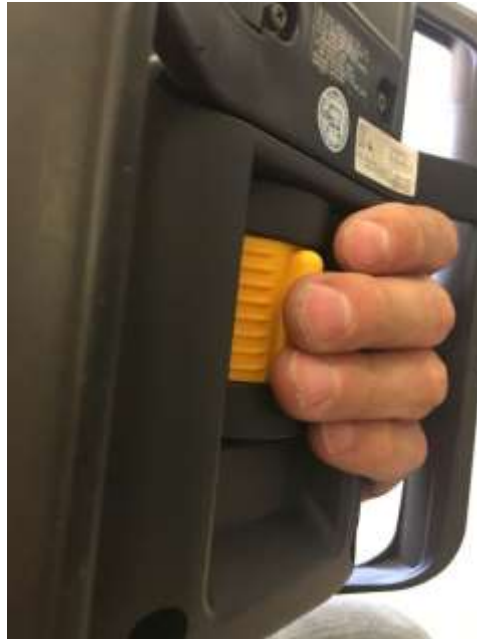
Figura 14-26. Paso 5. Activación de DEAD MAN SWITCH detrás del TEACH PENDANT.
