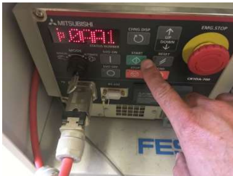
Figura 12-48. Paso 7. Al oprimir el botón verde START, se empezará a correr la rutina.
