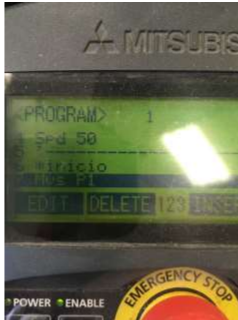
Figura 11-37 Paso 6. Selección de renglón donde aparece P1 usando las flechas del TEACH PENDANT.
