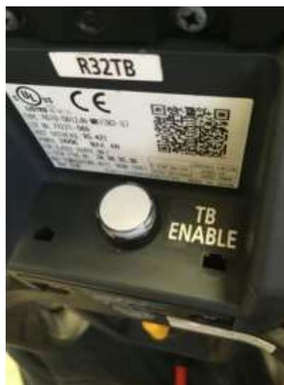
Figura 13-40 Paso 7. Botón TB ENABLE apagado al reverso del TEACH PENDANT.
