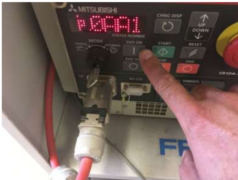
Figura 13-46. Paso 7. Encender los servos utilizando el botón SVO ON en el controlador.
