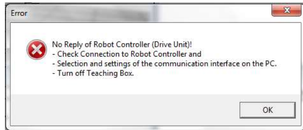
Figura 15-19. Paso 4. Comunicación fallida entre el Robot y Ciros.
