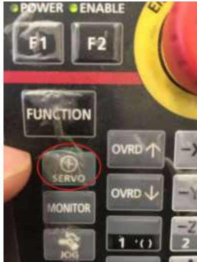
Figura 11-29. Paso 5. Botón para encender servomotores, en el TEACH PENDANT.
