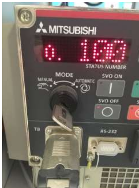
Figura 11-24. Paso 5. LLAVE DE MODO en el controlador en posición MODO MANUAL.
