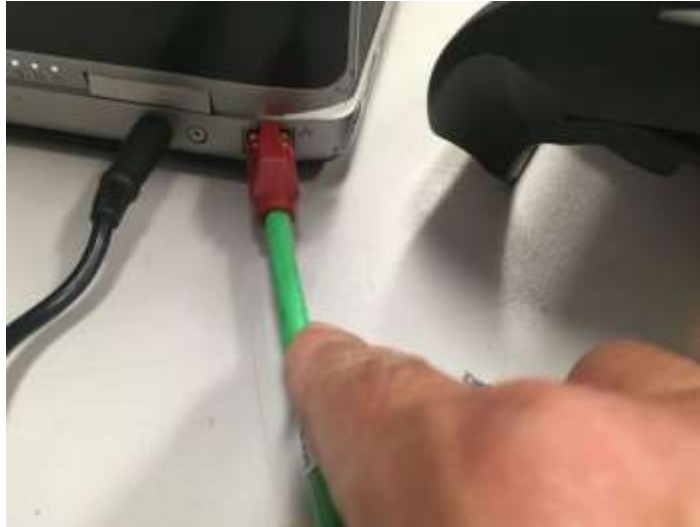
Figura 14-16. Paso 4. Conecte un extremo de un cable patch cord ethernet a la tarjeta de red del equipo de cómputo con Ciroc instalado.
