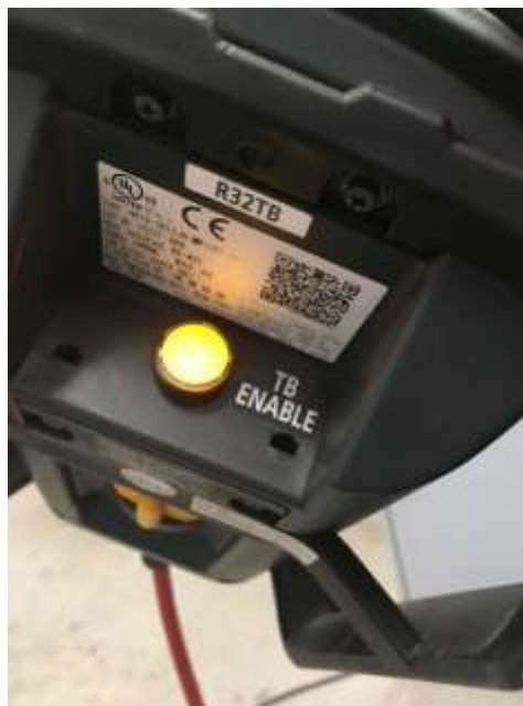
Figura 14-25. Paso 5. TB ENABLE del TEACH PENDANT encendido.
