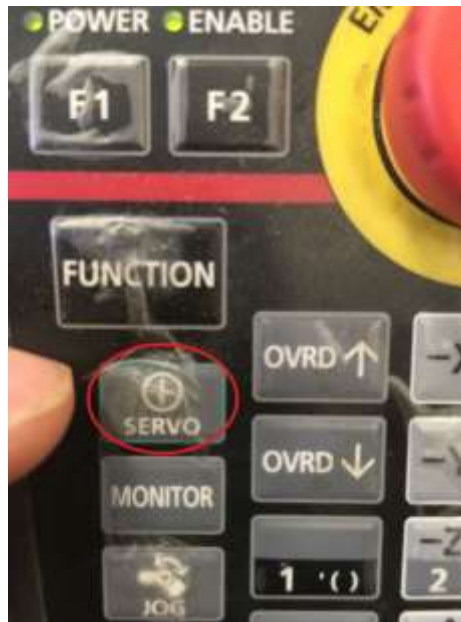
Figura 13-29. Paso 5. Botón para encender servomotores, en el TEACH PENDANT.
