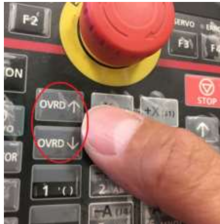
Figura 15-31. Paso 5. Teclas para subir y bajar la velocidad del robot. En el TEACH PENDANT
