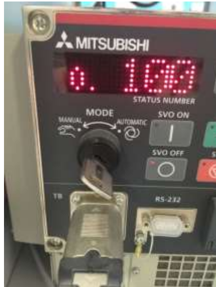
Figura 13-33. Paso 6. LLAVE DE MODO en la posición MANUAL
