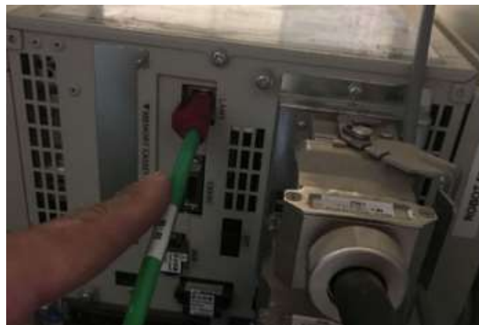
Figura 12-17. Paso 4. Conecte un extremo de un cable patch cord ethernet al puerto LAN del controlador del robot.
