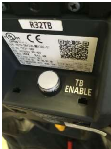
Figura 15-46 Paso 8. Botón TB ENABLE apagado al reverso del TEACH PENDANT.
