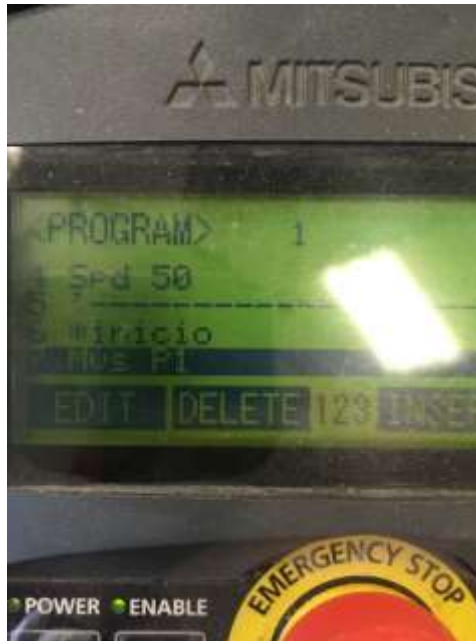
Figura 15-36 Paso 6. Selección de renglón donde aparece P1 usando las flechas del TEACH PENDANT.
