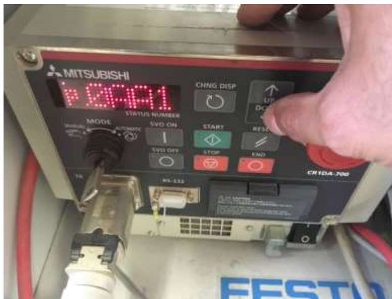
Figura 14-45. Paso 7. Uso de flechas UP DOWN en el controlador en MODO “P” para buscar el programa a ejecutar.
