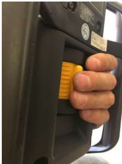
Figura 11-26. Paso 5. Activación de DEAD MAN SWITCH detrás del TEACH PENDANT.
