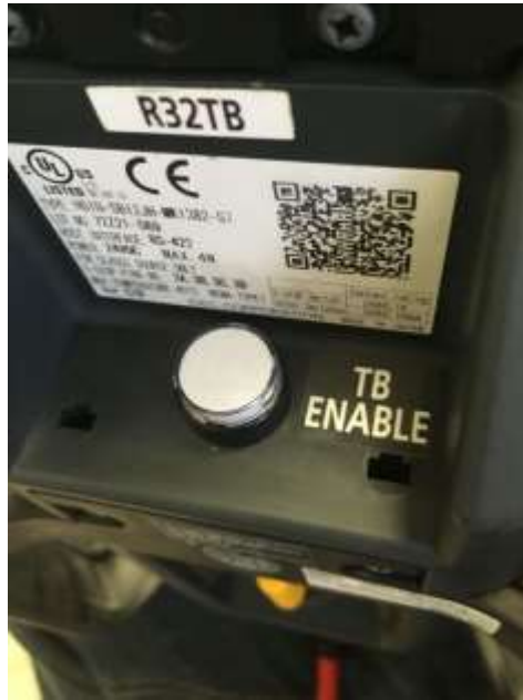
Figura 14-40 Paso 7. Botón TB ENABLE apagado al reverso del TEACH PENDANT.
