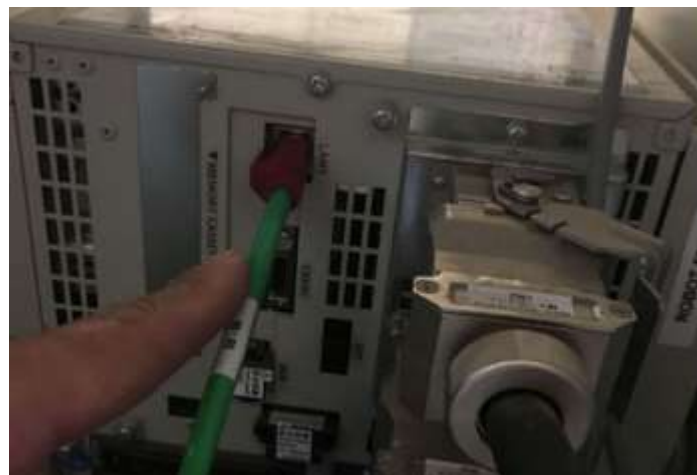
Figura 15-16. Paso 4. Conecte un extremo de un cable patch cord ethernet al puerto LAN del controlador del robot.
