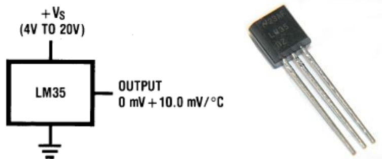
Fig. 65 Sensor de temperatura LM35 esquemático y físico.
