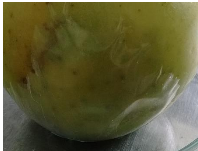
Figura 3.18. Formación de una burbuja en la película de pectina-alginato-aceite de orégano.
