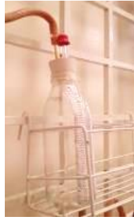
Figura B.15 Sistema de captación de lixiviados
