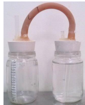
Figura B.14 Sistema de medición de biogás
