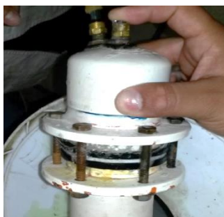
Figura B.7 Prueba de hermeticidad neumática
