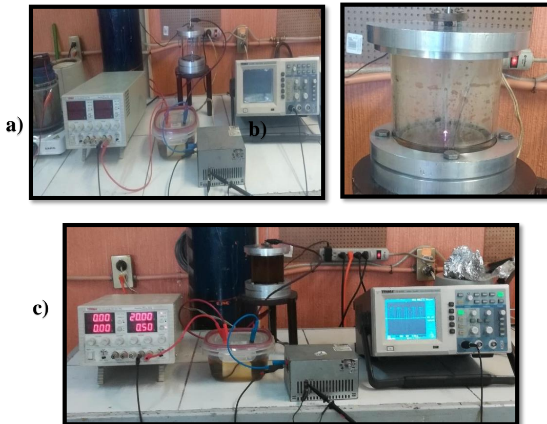
Figura 3.5 a) Reactor conectado. b) Rayo de plasma. c) Reacción de polimerización.
