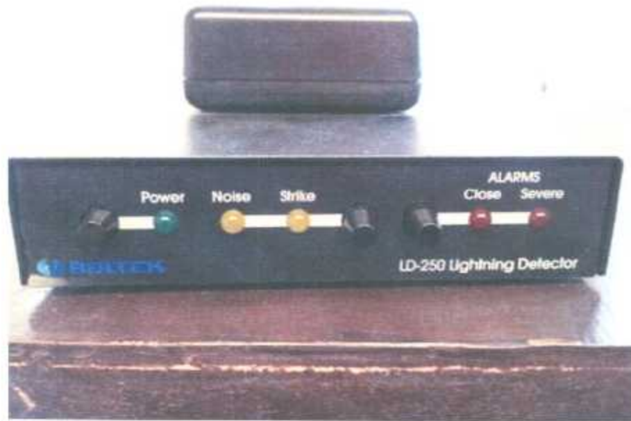
Figura A.1: Boltek LD-250. Cortesía de Subgerencia de Subestaciones y Líneas Región Norte de CFE.
