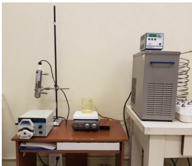
Figura 2. Sistema ensamblado para los experimentos de degradación de NB.
