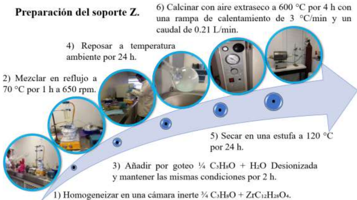
Figura 3.2 Esquema de la preparación del soporte Z.
