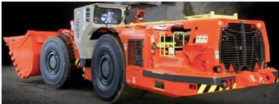
Figura 10. Cargador de bajo perfil "Scooptram".
