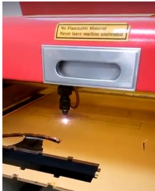
Figura 26. Corte de acrílico de 0.5 cm de espesor.
