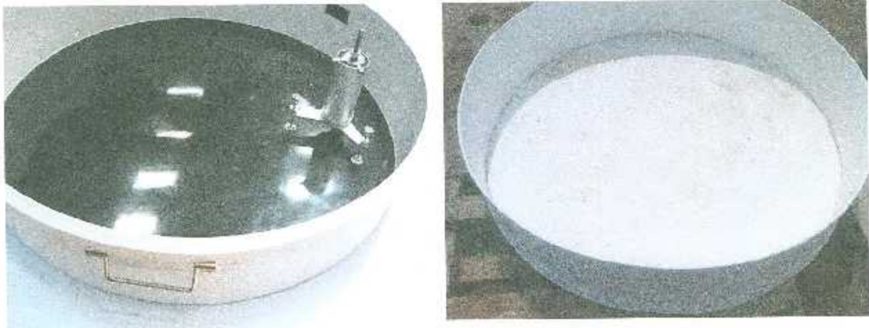
Figura 12. Lado izquierdo: tanque evaporímetro para venta, lado: derecho tanque evaporímetro hecho en las instalaciones del ITT
