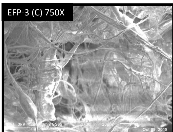
Figura 31. Imagen SEM del andamio EFP en cilindro rotatorio a 750X.
