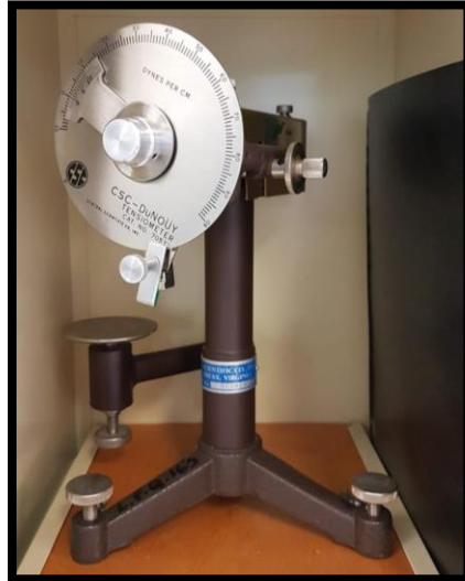
Figura 16. Tensiómetro de anillo DSC-DuNOUY No. 7035.
