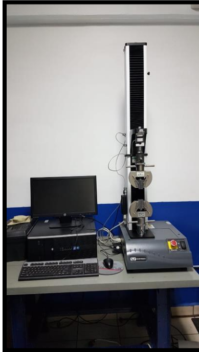
Figura 14. Equipo BlueHill Lite de Instron modelo 2519-107
