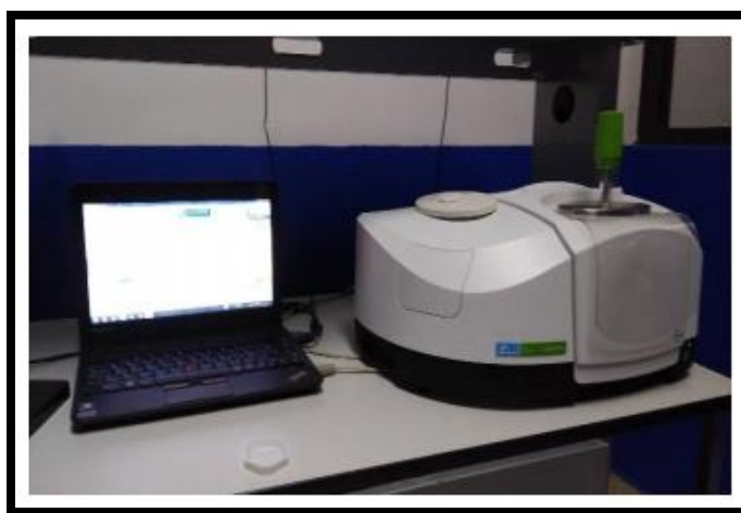
Figura 10. Equipo de FTIR, marca PerkinElmer modelo Spectrum two.
