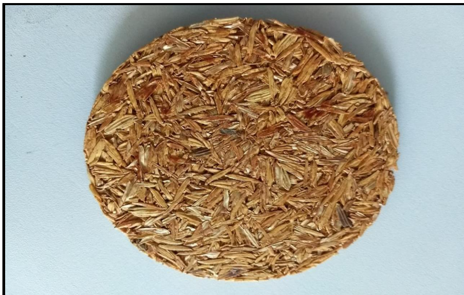
Figura 4.13 Material compuesto elaborado a partir de cascarilla/resina fenólica.
