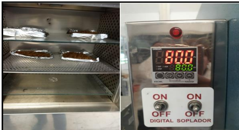
Figura 4.4 Cascarilla de arroz con tratamiento con agente compaibilizante en horno a 80°C.
