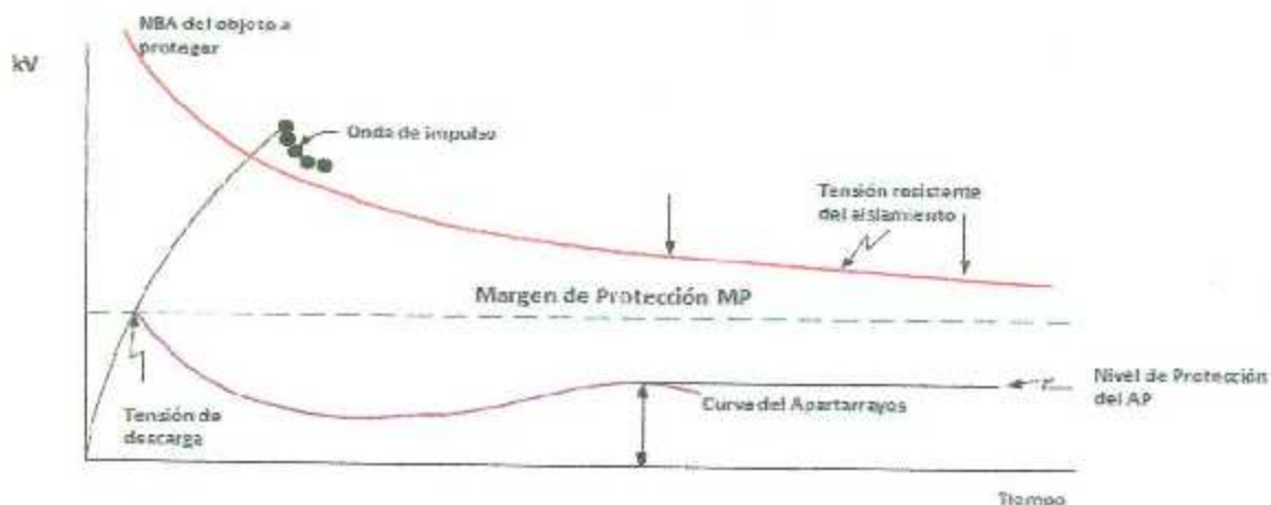
Figura B.2.4. Tensión de aguante del aislamiento, Nivel de protección del Apartarrayos.
