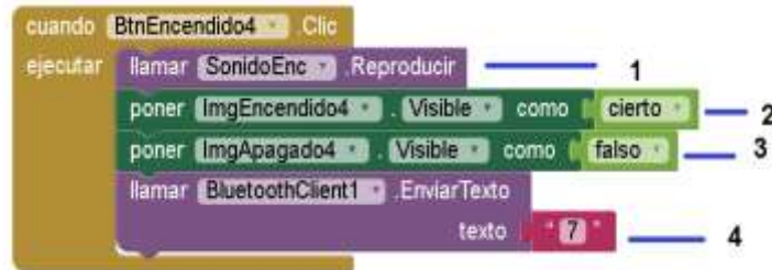
Figura 49 Bloque de programación del botón de encendido
