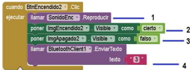
Figura 43 Bloque de programación encendido de la lámpara fija 2
