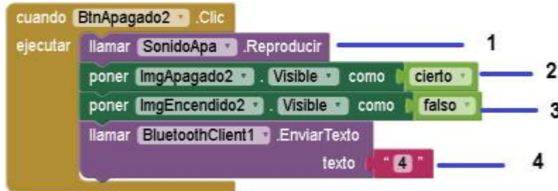
Figura 44 | Bloque del botón apagado de la lámpara 2
