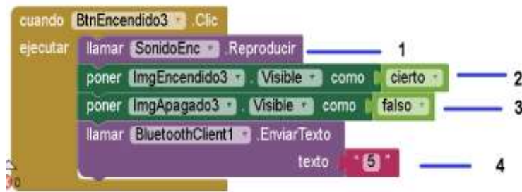
Figura 46 Bloque del botón de encendido de la lámpara fija 3
