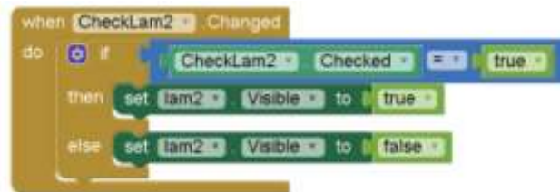
Figura 56 Bloque de programación del checkBox2
