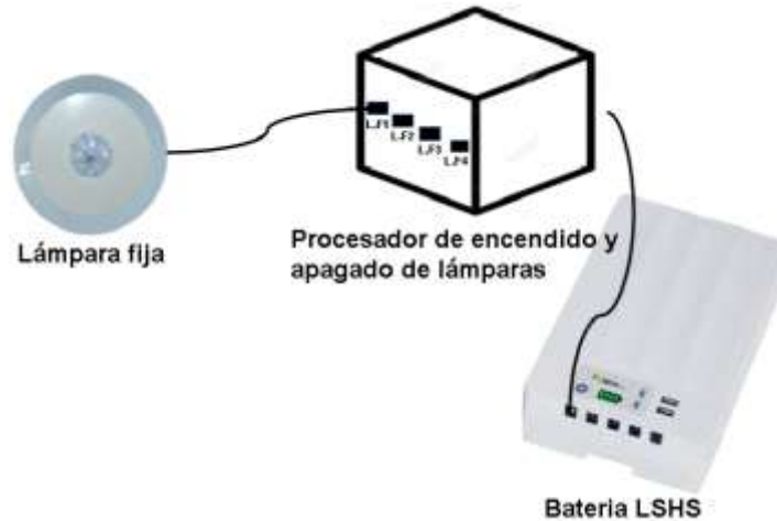
Figura 82 Conexión de la lámpara fija al procesador de lampras fijas
