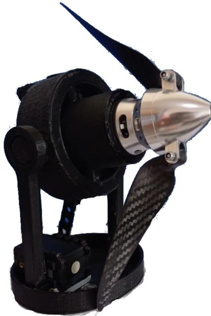
Figura 5.9: Vector de empuje diseñado para el VTOL
