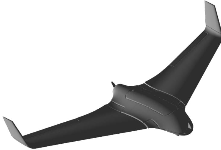
Figura 4.1: Avión de ala fija Skywalker x8
