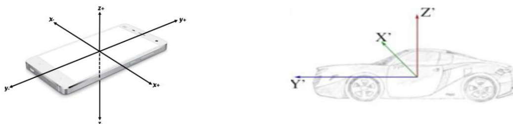
Figura 9. Sistema de referencia utilizado con respecto al vehículo y el teléfono. Fuente [6].
