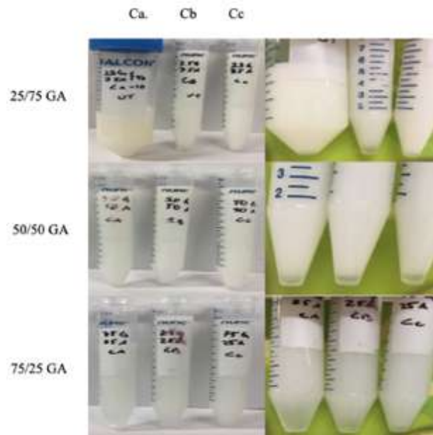
Figura 3.12 Nanoemulsiones de la segunda etapa procesadas únicamente por el homogenizador de alta velocidad al día 30, se observa separación de fases en todas las muestras.
