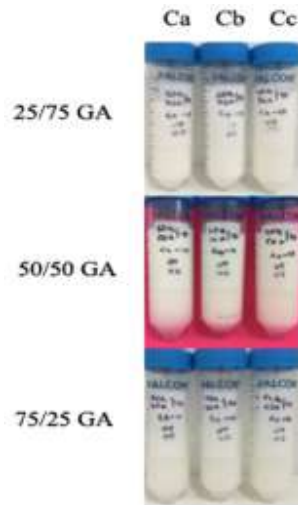
Figura 3.8 Nanoemulsiones de la segunda etapa al día 36, se observa separación de fases en las muestras elaboradas con el 50% cosurfactante en la fase continua.
