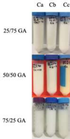
Figura 3.3 Nanoemulsiones de la primera etapa al día 44, se observa separación de fases en las muestras elaboradas con el 50% de cosurfactante en la fase continua.
