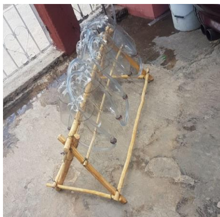
Figura 28. Prototipo de calentador solar propuesto para la intervención
