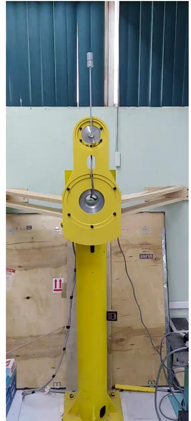
Figura 3.5: Pendubot del laboratorio de Mecatrónica y Control del I.T. de la Laguna.
