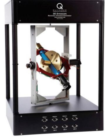
Figura 3.3: Plataforma Giroscópica de Quanser.
