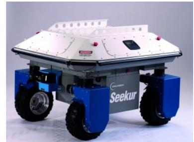
Figura 1.2: Robot móvil con ruedas SEEKUR de la Empresa MobileRobots.
