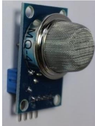
Figura 5. 10. Sensor de metano MQ-4.
